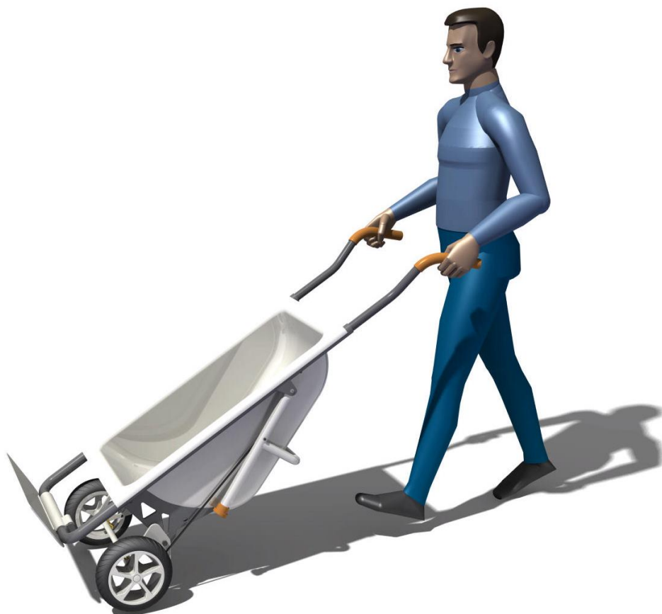
Obr. 38 Manipulátor v módu rudl s obsluhou
