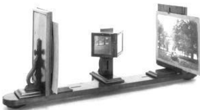
Obr. 1 Stereoskop vynalezený Charlesem Wheatstonem – převzato z [7].
