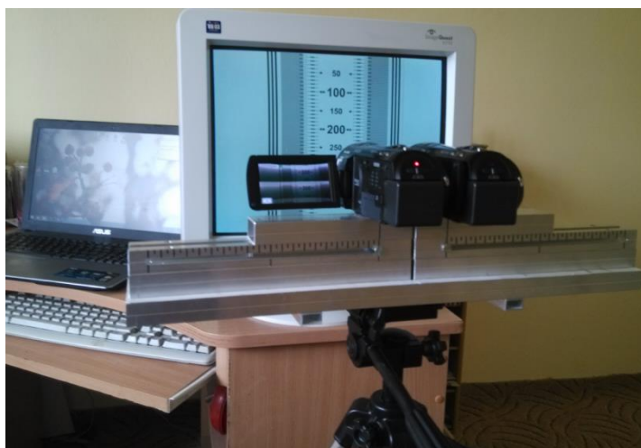
Obr. 5 Měření synchronizace pomocí CRT monitoru.
