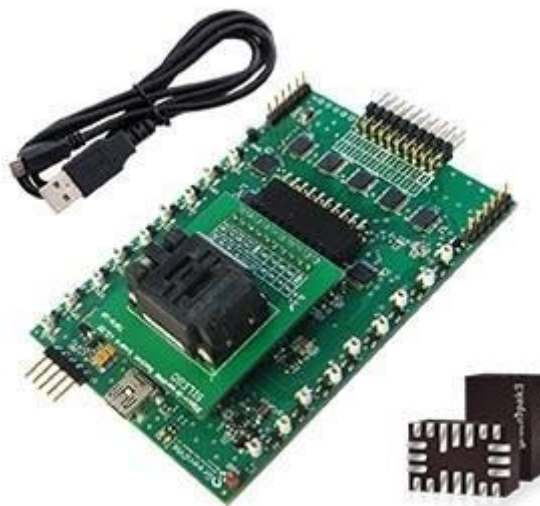
Obr. 3.4 Obvod GreenPAK3 s vývojovým kitem [převzato z 10]
