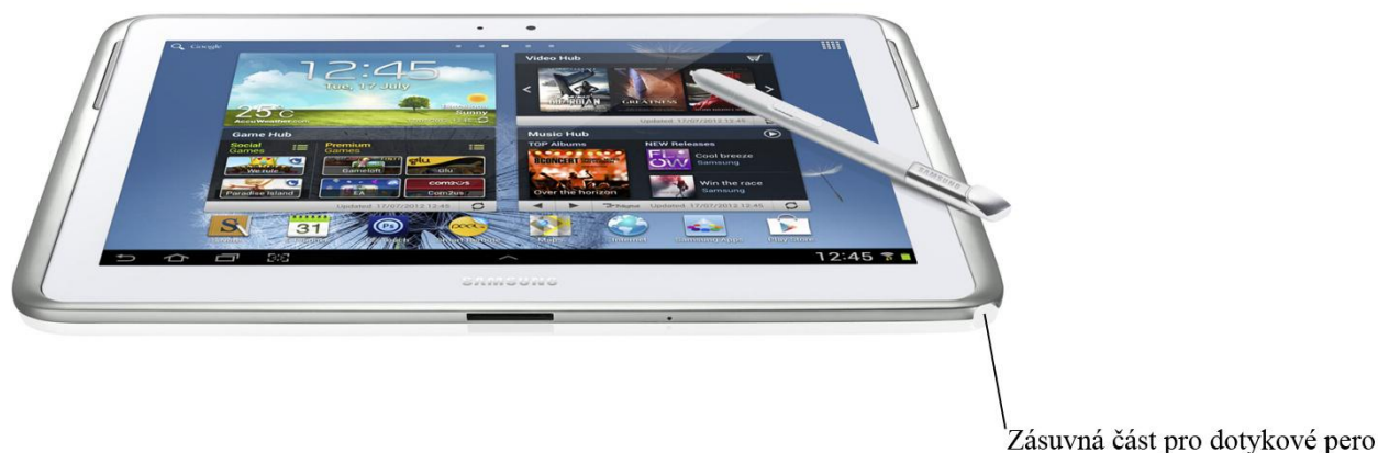
Obr.6 Možnost zasunutí dotykového pera do těla tabletu [8]
