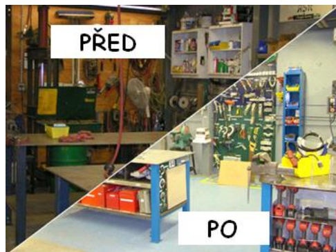
Obr. č. 19 : Testování pracoviště č. 1 před a po zavedení metody 5 S
