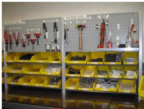
Obr. č. 20: Testovací pracoviště č. 2 po zavedení metody 5 S
