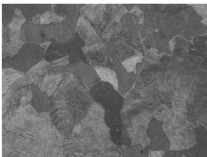
Obr. 26 Výchozí stav materiálu, podélný směr, 1000x
