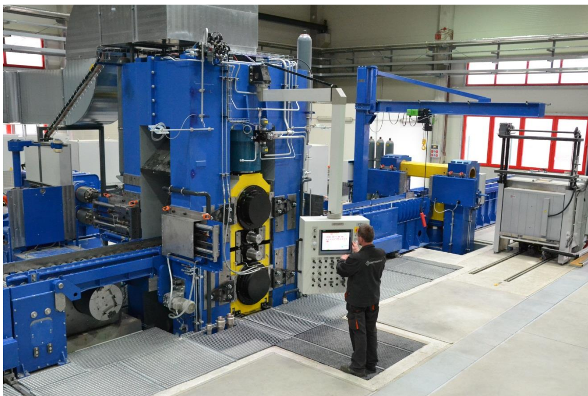
Obr. 18 Laboratorní válcovací trať ve firmě COMTES FHT a.s. s nastavením kvarto pro válcování za studena
