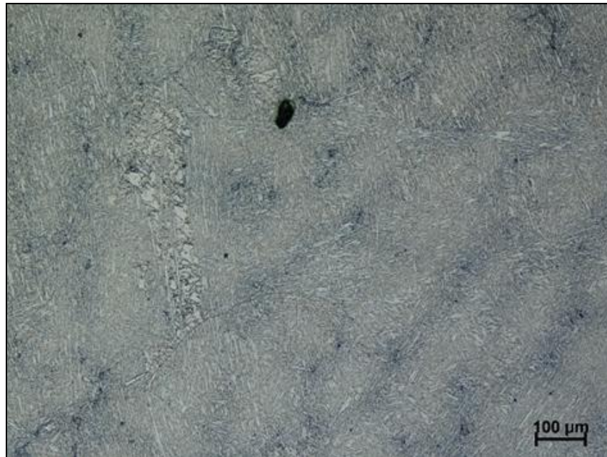
Obr. 25 Mikrostruktura ze světelného mikroskopu vzorku A1, zvětšeno 100x
