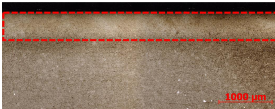
O- VI Rovnoměrná vrstva vnitřní plochy otvoru 25 mm od kraje (vzorek 02B, zvětšeno 25x, leptáno 3% Nital)
