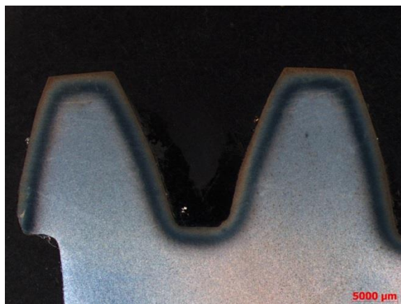
Obr. 3.4-14 zub ozubeného kola ocel 16MnCr5 (zvětšení 10x, leptáno 5%Nital)
