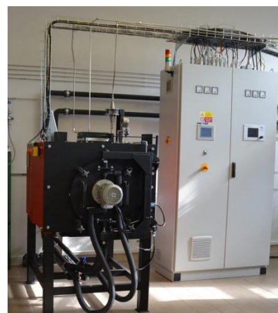
Obr. 3.2-3 Nitridační pec na ZČU v Plzni
