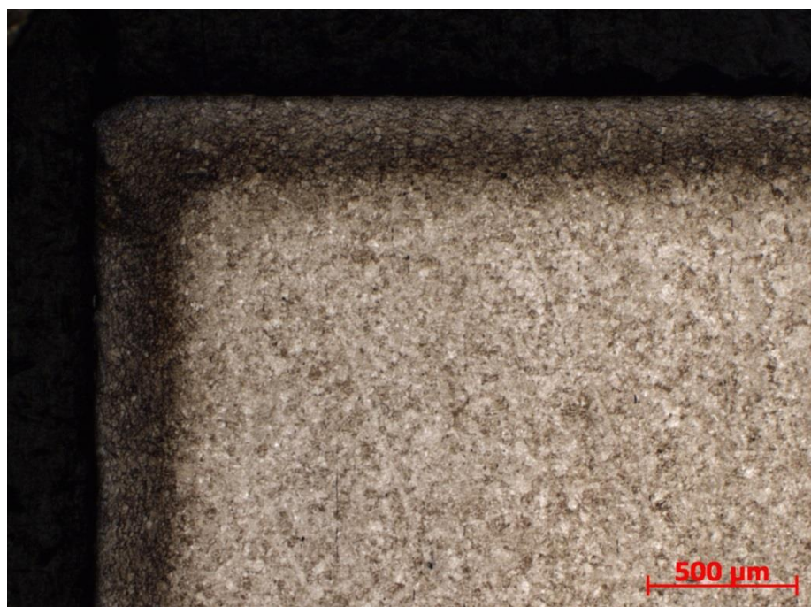
O-X Proces nitridace II – vzorek 51 ocel 31CrMoV9 - rovnoměrná nitridovaná vrstva (zvětšeno 25x leptáno 3% Nital)
