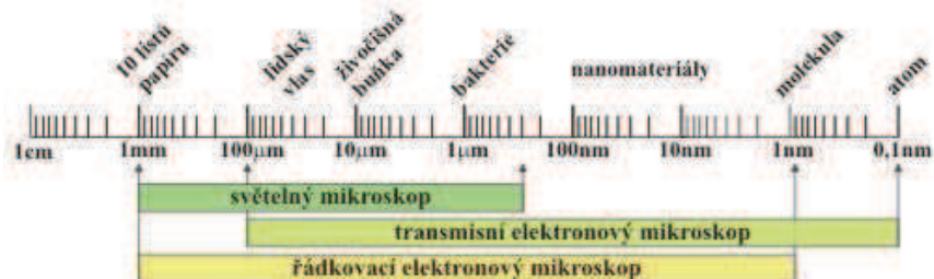
Obrázek 6:1. Typická velikost objektů, které lze pozorovat elektronovým mikroskopem. Pro srovnání je uveden i rozsah světelného mikroskopu.[22]
