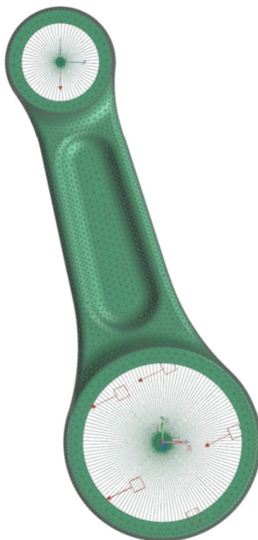
Obr. 6.2 - Na ojnici vytvořena síť
