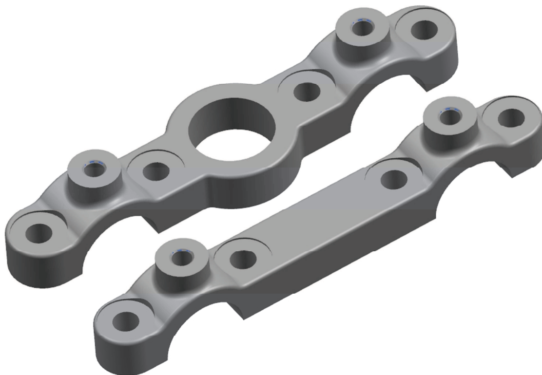
Obr. 5.30 - Klemy vačkových hřídelů
