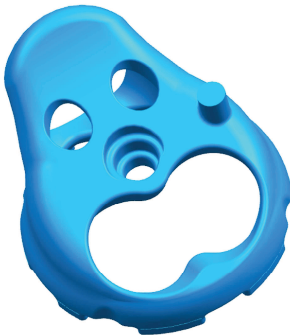
Obr. 5.26 - Jádru vodního prostoru hlavy válce pohled shora
