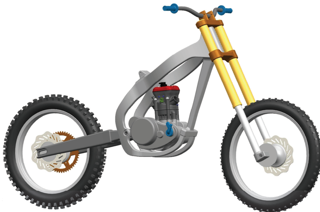
Obr. 5.2 - Navržený motor v rámu motocyklu pohled zprava
