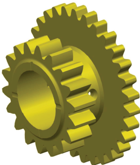
Obr. 5.18 - Vložené kolo rozvodového mechanismu
