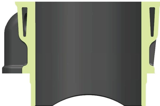
Obr. 5.22 - Podélný řez válcem
