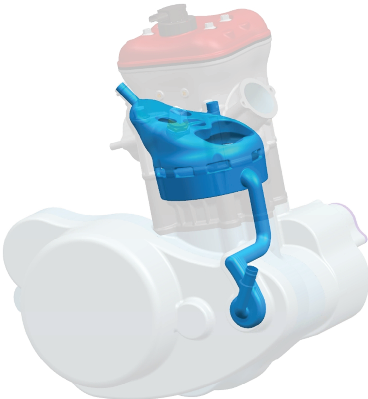
Obr. 5.36 - Chladicí systém motoru
