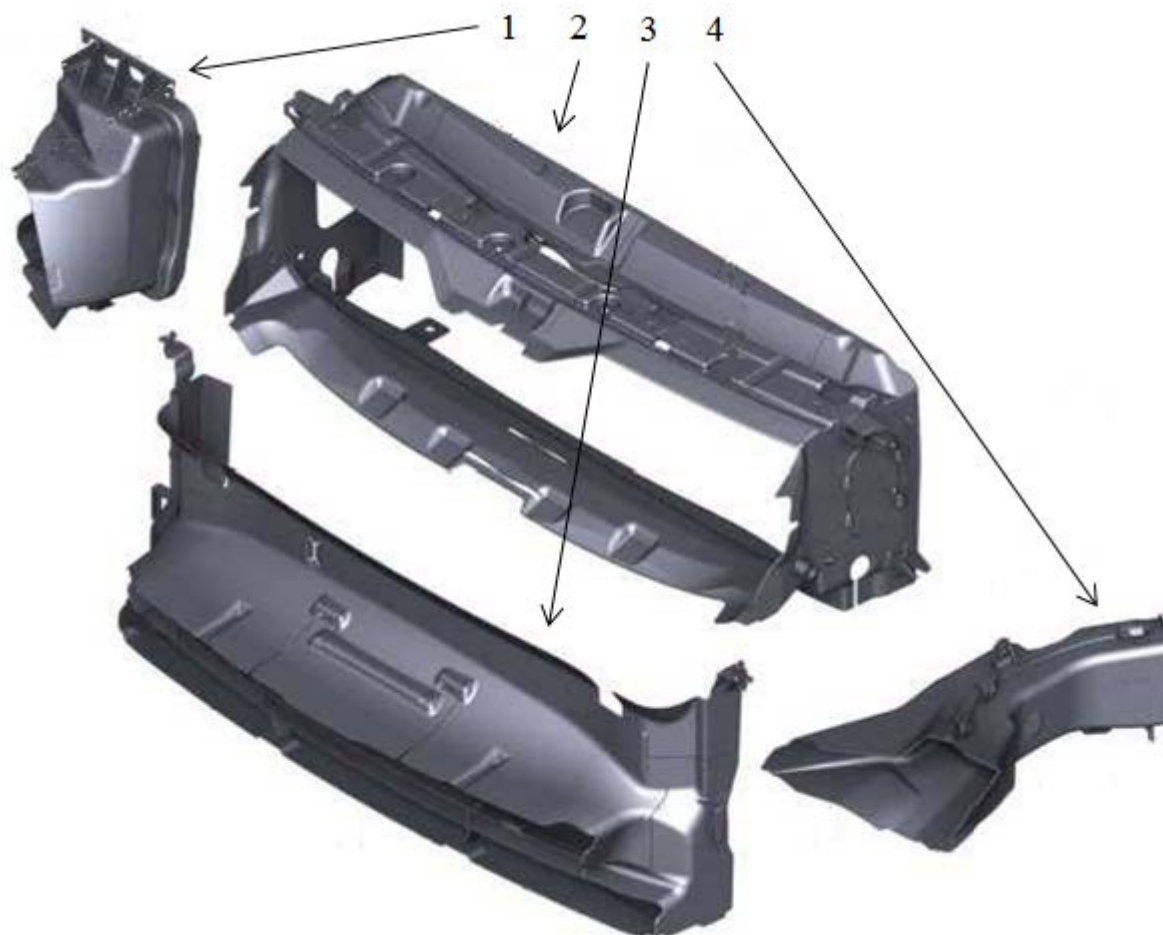
Obr. 9 - Ukázka vedení vzduchu[12]. 1 – vedení pro chladič vzduchu umístěný před předním blatníkem, 2 – vrchní díl vedení vzduchu, 3 – spodní díl vedení vzduchu, 4 – vedení pro přívod vzduchu na brzdy.
