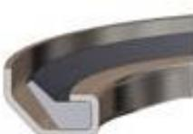
Axiální těsnění se používají především v kombinaci s radiálními těsnícími kroužky hřídele. Používají se jako modulární předřazený těsnicí prvek pro utěsnění před nečistotami, prachem, tukem a proti stříkající vodě z vnějšku. Axiální těsnění se skládají ze dvou složek - z kovového kroužku a z pryže.
