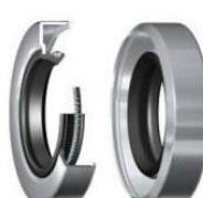
Těsnění s jedním těsnícím břitem. Je opatřeno kovovým pouzdem a kovovou výztuží. Pro drsnější provozní podmínky a větší rozměry. Gufero je díky výztuži odolnější vůči chybám při montáži.
