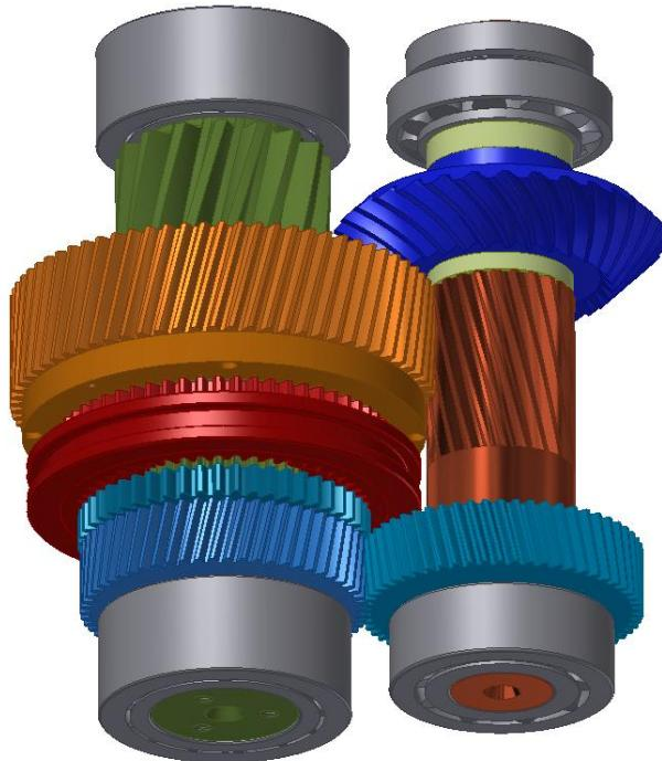
Obr. 9-5 3D model soukolí 1,2; soukolí 3,4; přesuvná spojka
