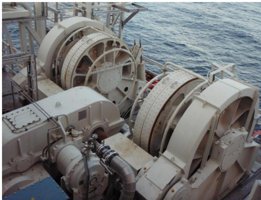
Obr. 2-6 Čelní převodovka pro naviják kotevního lana [18]
