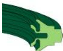
Těsnění se dvěma těsnícími břity k utěšňování dvou médií. Gufera WAD mají vnější pryžový plášť. Těsnění se čtyřmi břity jsou ještě účinnější. Mají nižší tření. Nahrazují těsnění se dvěma břity pro vyšší otáčky hřídele. Výroba ze vstřikovaného termoplastického elastomeru (TPE).
