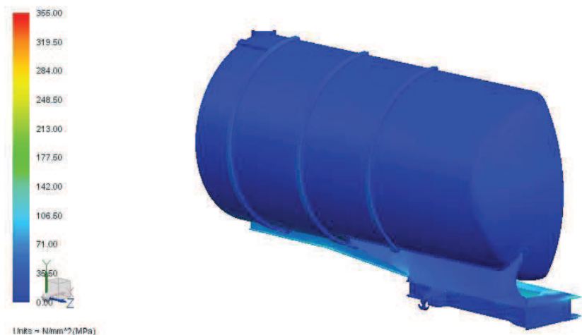
Obr. 85 Napětí Von Mises [MPa]
