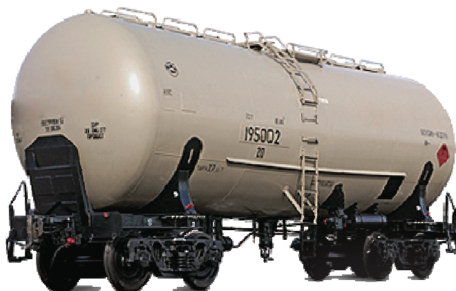
Obr. 15 Cisterna bez hlavního rámu [11]
