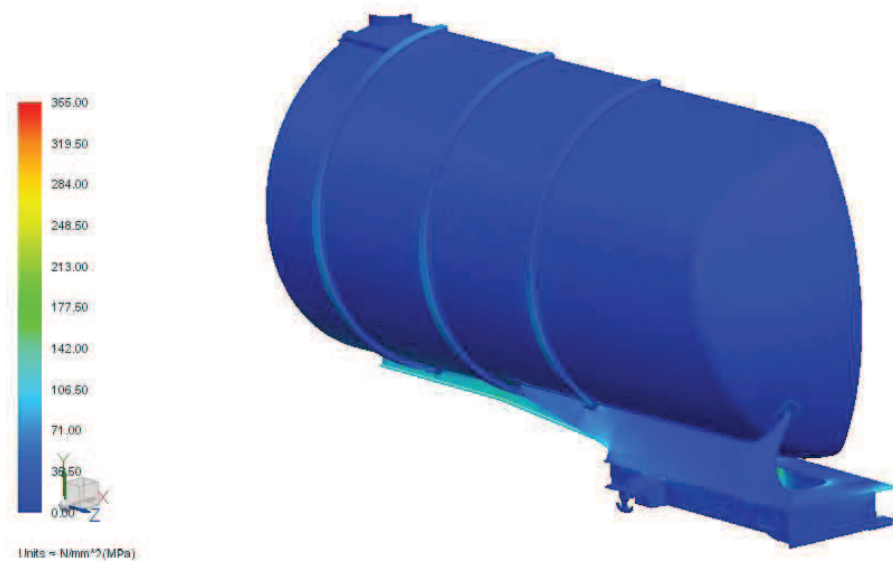
Obr. 80 Napětí Von Mises [MPa]
