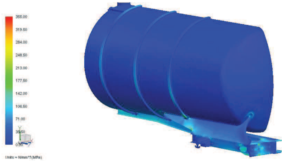
Obr. 75 Napětí Von Mises [MPa]
