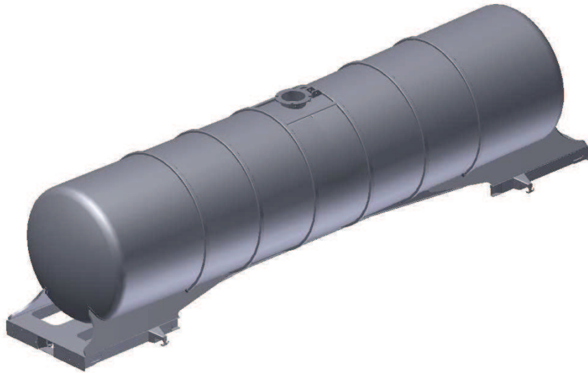
Obr. 57 Kotel s představky - pohled 1
