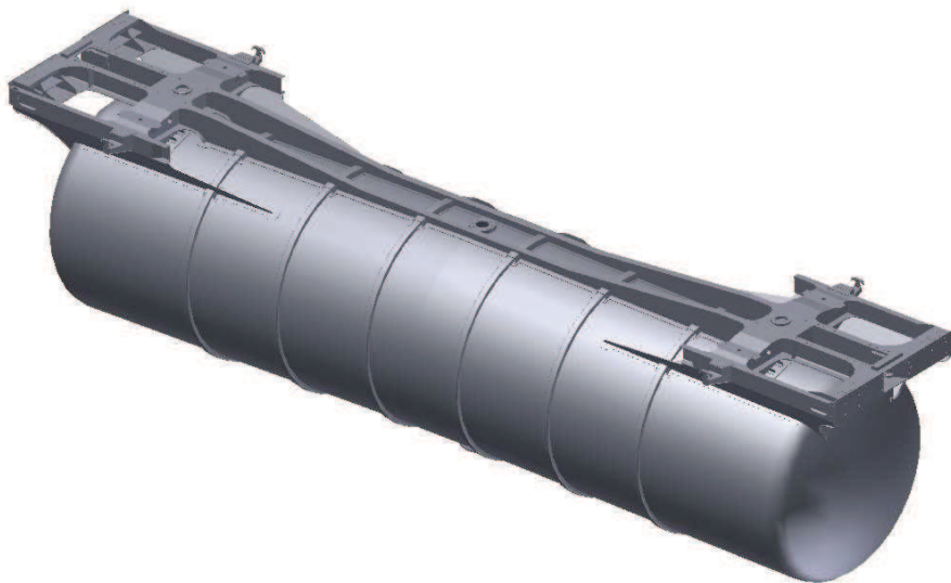
Obr. 57 Kotel s představky - pohled 1
