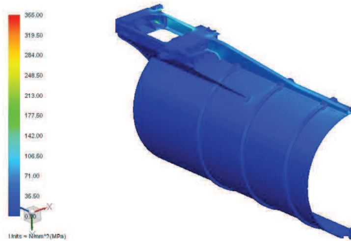
Obr. 90 Napětí Von Mises [MPa]
