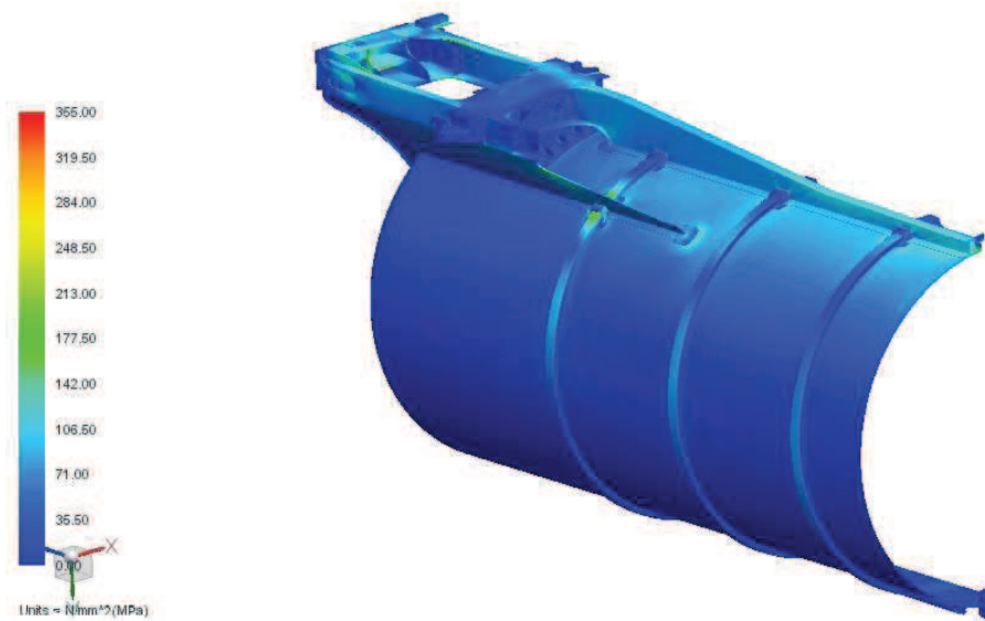
Obr. 76 Napětí Von Mises [MPa]
