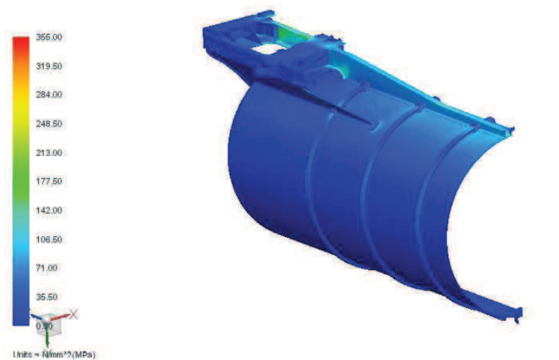
Obr. 86 Napětí Von Mises [MPa]
