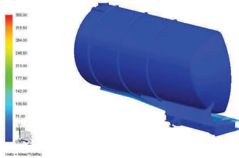
Obr. 89 Napětí Von Mises [MPa]
