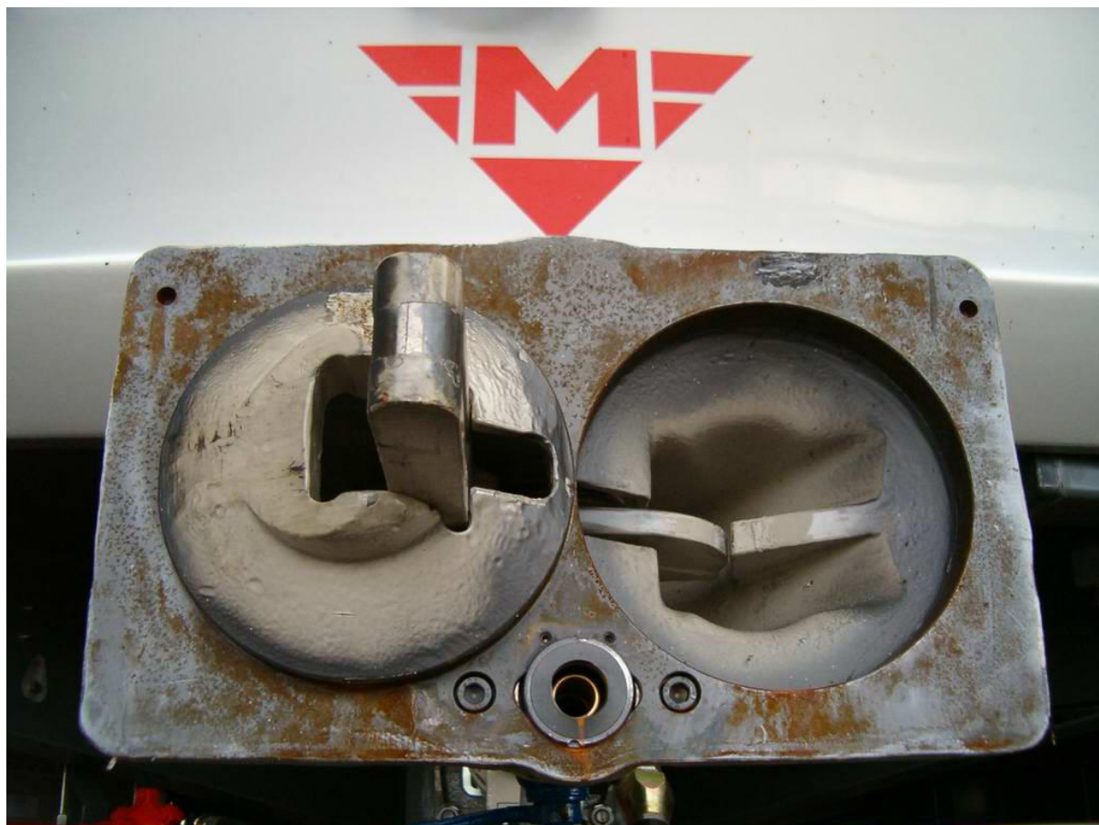
Obrázek 9: Hlavové automatické spřáhlo jednotky Siemens M1 [5]
