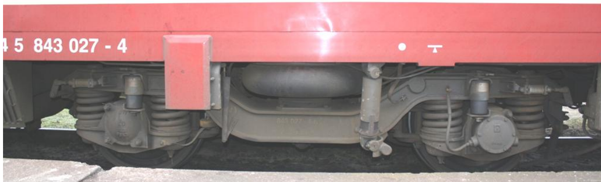
Obrázek 2: Vypružení trakčního podvozku vozu 843
