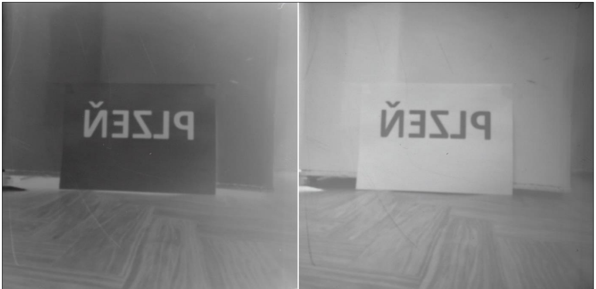
Negativ/pozitiv vyfotografovaný pomocí dírkové komory.
