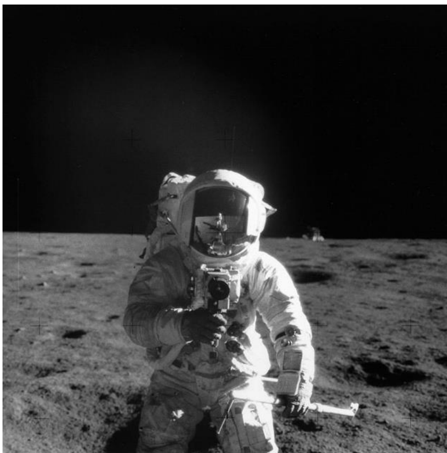
Obr. č. 53: Fotografie obsahující měřicí křížky (z povrchu Měsíce). [115]
