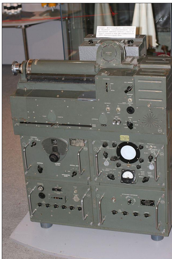
Obr. č. 16: Fototelegrafický box z vesmírné sondy Luna 3. [63]
