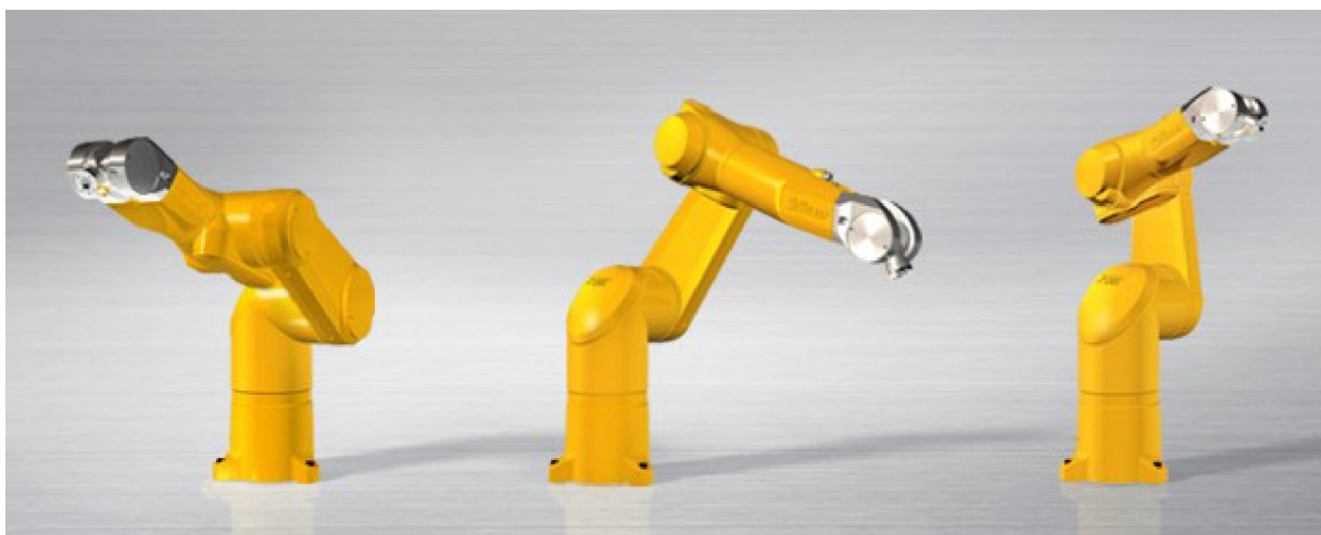
Obr. 5.8: 6-osé robotické rameno Staubli TX60. [Převzato z [17]]
