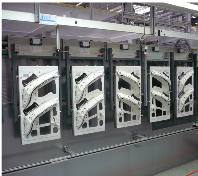
Obr. 5.1: Pohled na nosné plechy (sputter-plechy) dílců.
