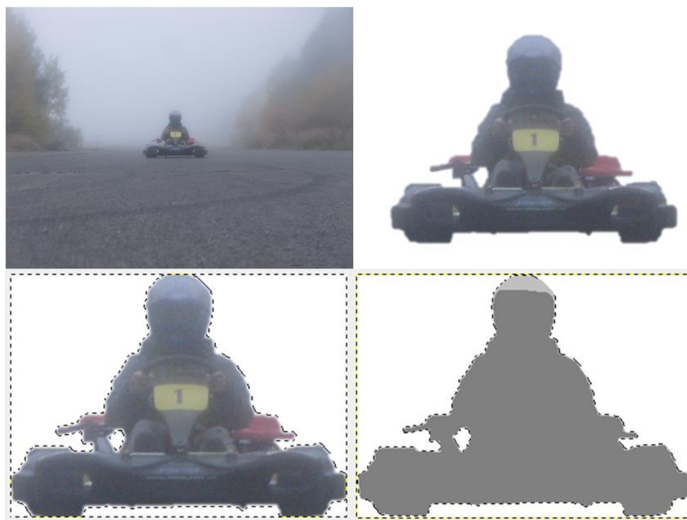
Obr. 8 Úprava fotografie pro určení čelní plochy motokáry s jezdcem
