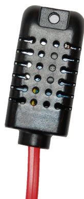
Obr. 2.5: Ukázka použitého kombinovaného senzoru AM2301.
