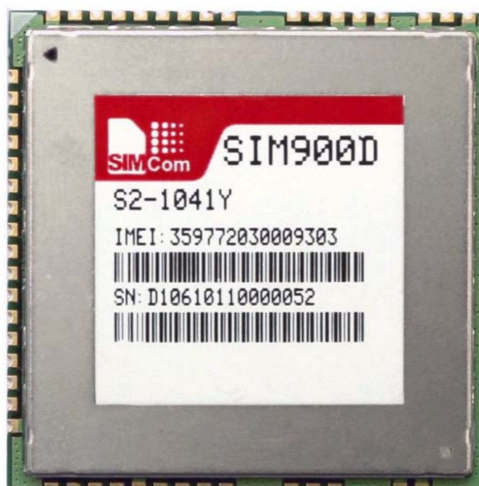
Obr. 2.1: Ukázka vybraného komunikačního GSM modulu SIM900D od firmy SIMCom. [Převzato z [5]]
