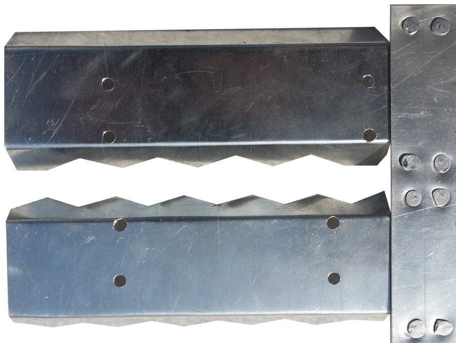
Obrázek 7: Zadní strana úhlového reflektoru pro jednotku Omnitik U5HND
