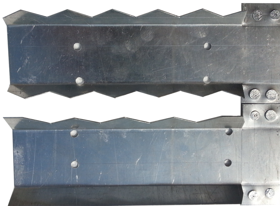
Obrázek 6: Přední strana úhlového reflektoru pro jednotku Omnitik U5HND
