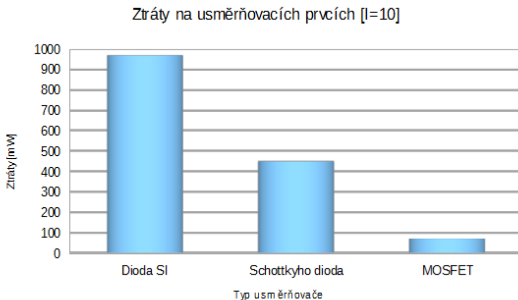
Obr. 3.1.2 Graf porovnání ztrát na usměrňovacích prvcích [17, s. 11]
