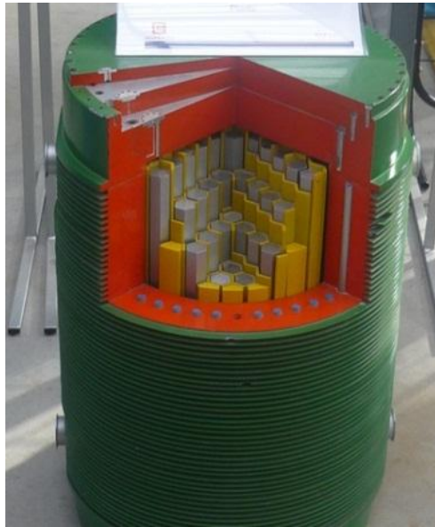
Obrázek 6 - Reálný model kontejneru CASTOR 440/84
