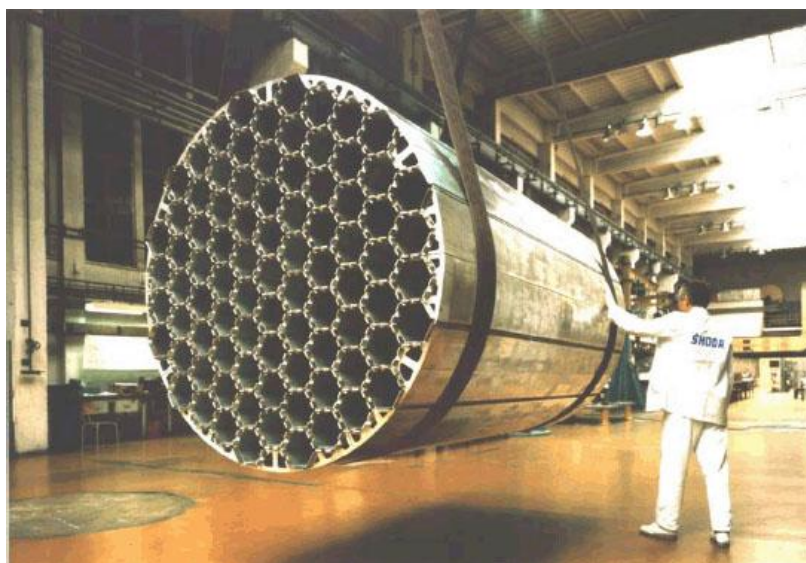
Obrázek 8 - Palivový koš dle vlastního návrhu Škoda JS a.s.
