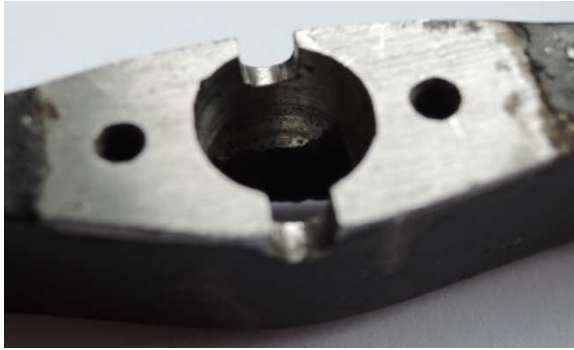
Obr. 5 Kulové zhloubení pro ukotvení táhla
