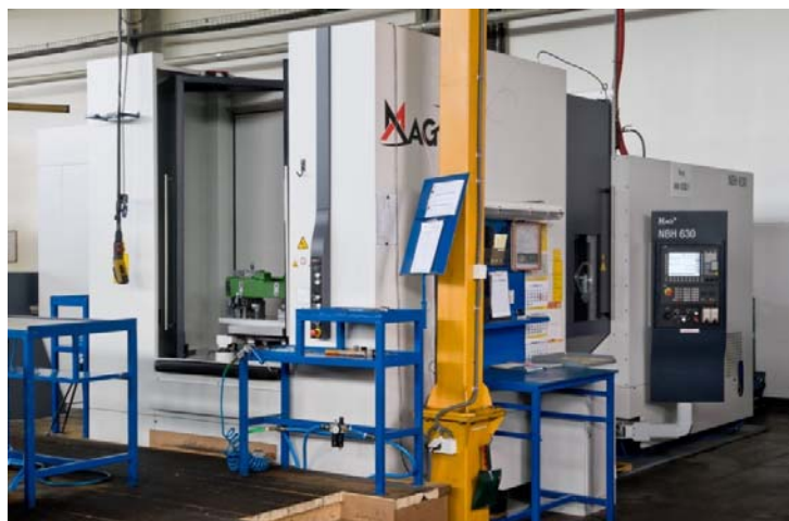
Obrázek 3 – CNC obráběcí centrum Hüller-Hille nbh 630 [1]
