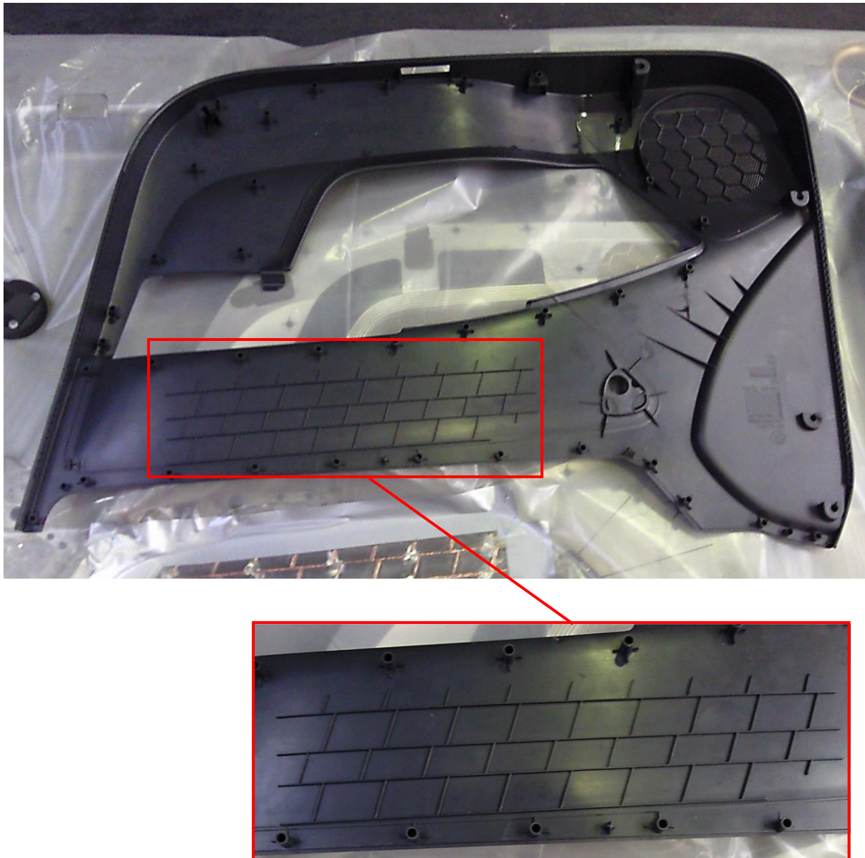
Obr. 4.16: Vnitřní výplň dveří včetně detailního pohledu na žebra, jež bylo nutné odstranit [12]
