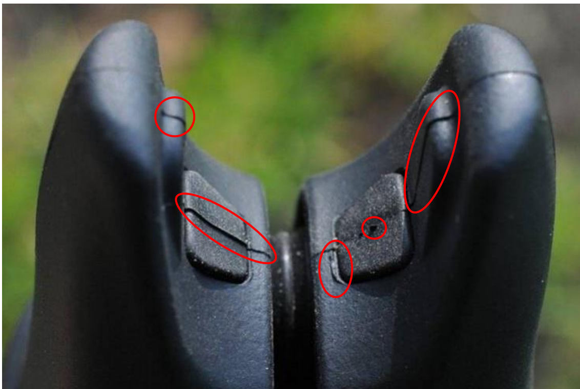
Obr. 4.20: Plastový díl s vyznačenými zástříky [29]
