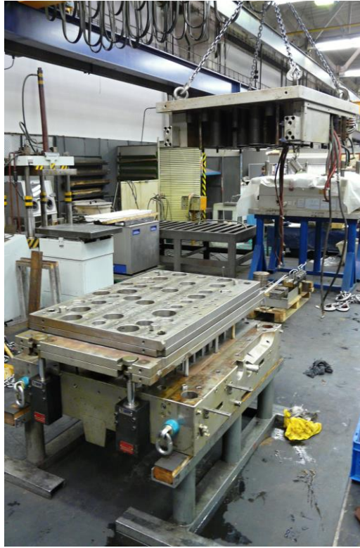
Obr. 4.10: Odejmutí upínací desky spolu s bočními sloupky [12]
