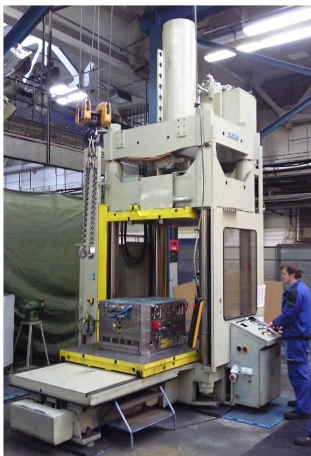
Obr. 3.2: Lícování formy na tuširovacím lise o síle 200 tun [12]
