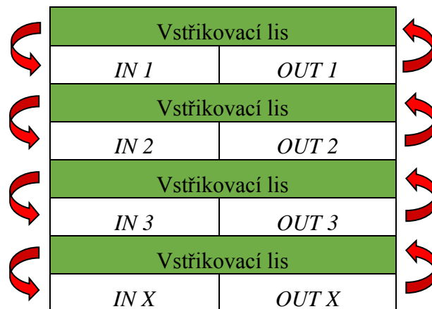
Tabulka 23: Schéma propojení chladicích okruhů u velkých forem. Šipky naznačují hadice.
