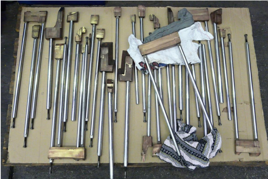
Obr. 2.1: Tvarové vyhazovače vyrobené ze slitiny AMPCOLOY [12]
