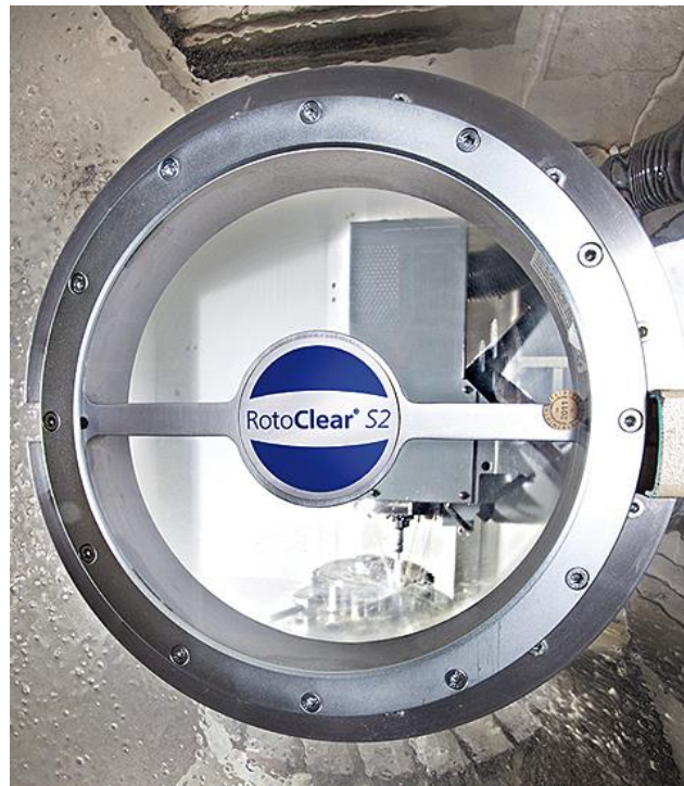
Obr. 5.1: ROTOCLEAR zajišťující jasný průhled do pracovního prostoru [3]
