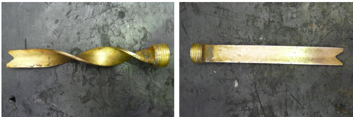
Obr. 4.24: Poškozená přepážka (levá část obr.) a ta samá přepážka po opravě (pravá část obr.) [12]
