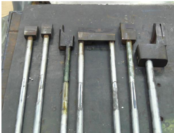
Obr. 4.14: Vyhazovače před (levá část obr.) a po provedení údržby (pravá část obr.) [12]
