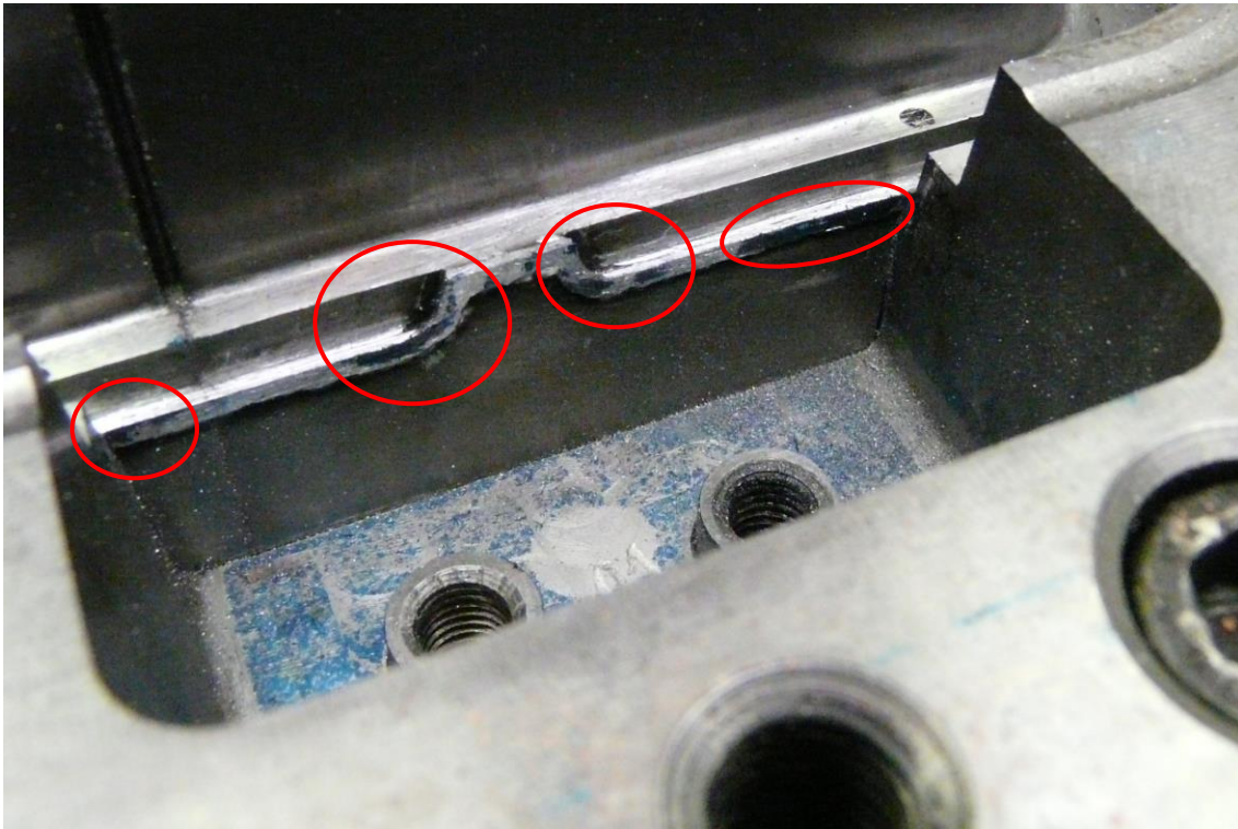
Obr. 4.23: Pohled na otisk signální barvy na svaru (červeně vyznačené), včetně otisku signální barvy na dně dutiny, což značí, že hlava vyhazovače na dno dosedá. [12]
