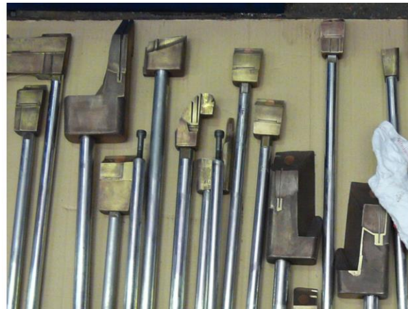
Obr. 4.14: Vyhazovače před (levá část obr.) a po provedení údržby (pravá část obr.) [12]
