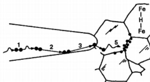
Obr. 9 Mechanismus vzniku vodíkové křehkosti [IX]
