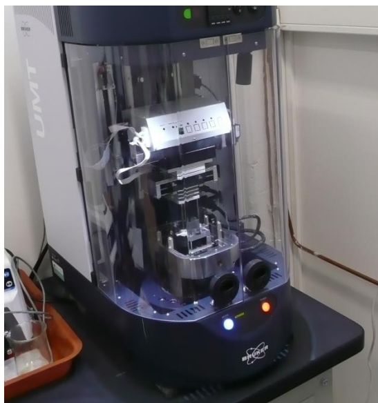
Obr.13: tribometr CETR-UMT3 fi. Bruke
