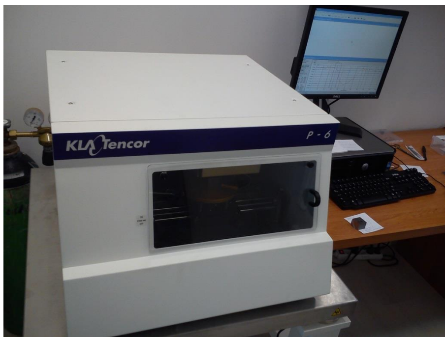
Obr.14: profilometr KLA TENCOR P-6
