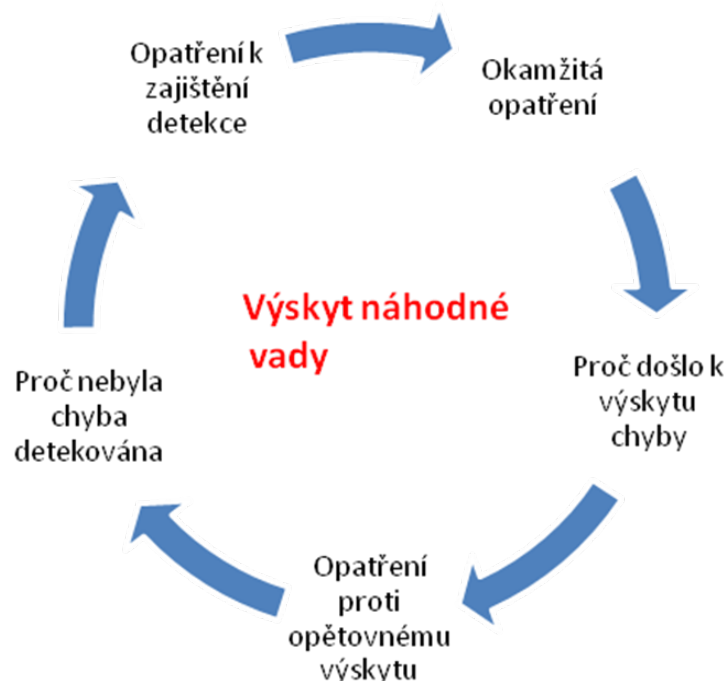
Obr.č. 29. Cyklus detekce a stanovení opatření u náhodných chyb (vlastní metoda a
