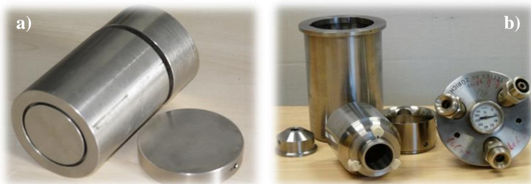
Obr. 9 Tříelektrodivý systém pro: a) měření pevných izolačních materiálů, b) měření kapalných izolačních materiálů.
