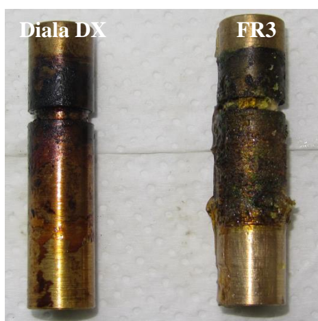
Obr. 33 Stav mosazných elektrod po ukončení experimentu při teplotě 110 °C v oleji Diala DX (nalevo) a FR3 (napravo).
