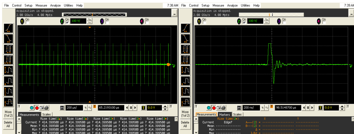
Obr. 31 Tvar proudových pulzů \pm 1,6 kV při 110 °C.
