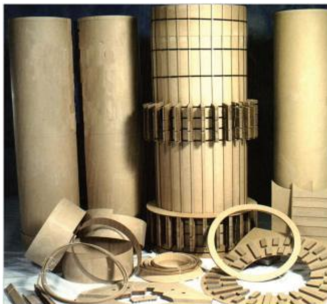
Obr. 2 Příklady materiálů z celulózy používaných v transformátorech. Převzato z [59].
