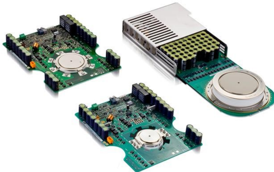
Obr. 2.9 IGCT od ABB (převzato z [18])
