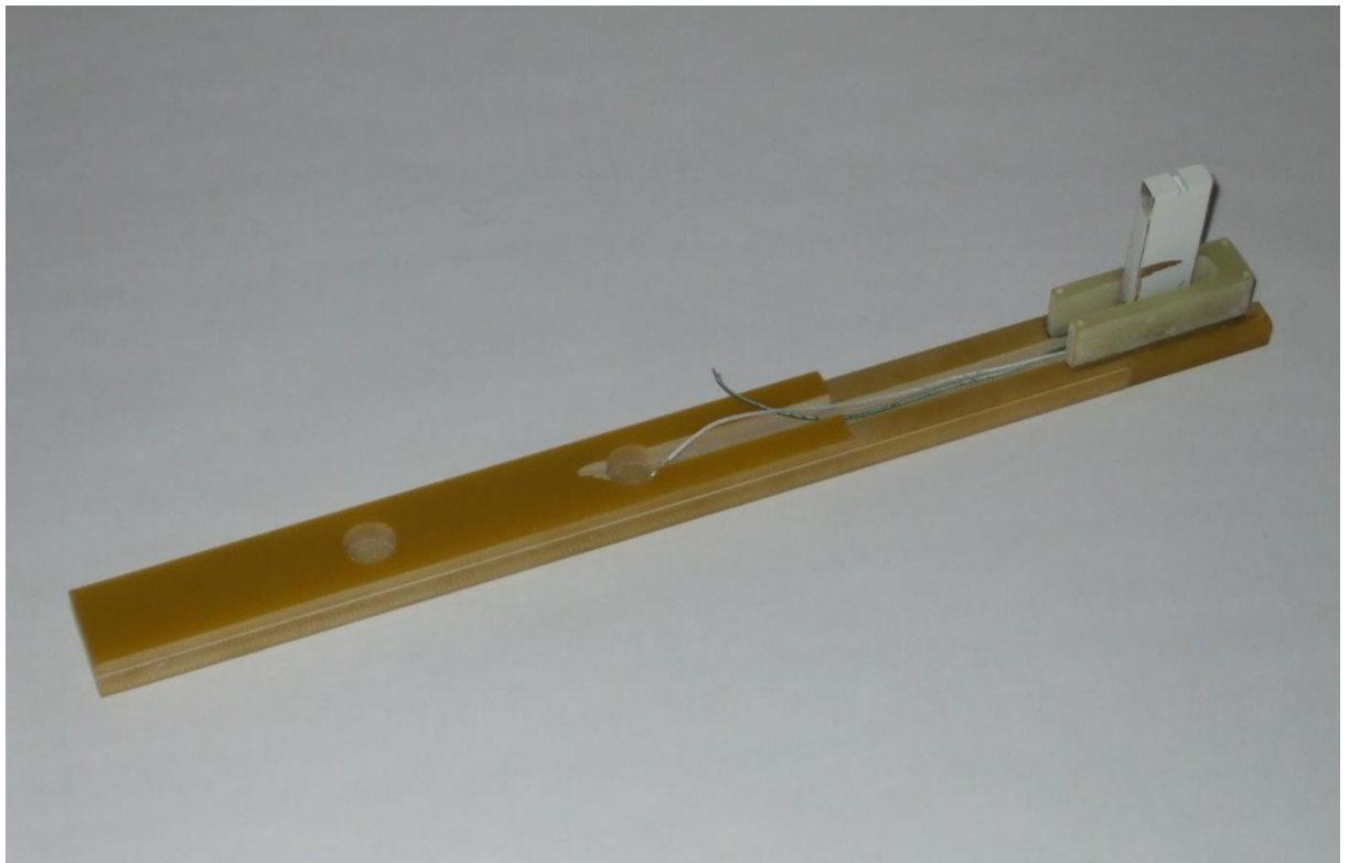
Obr. č. 7. Měřící klín s nalepenou sondou a drážkou s vývodními kabely
