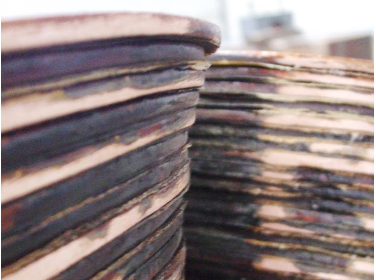
Obr. č. 3. Vytažení horních závitů cívky u turboalternátoru 50MW
