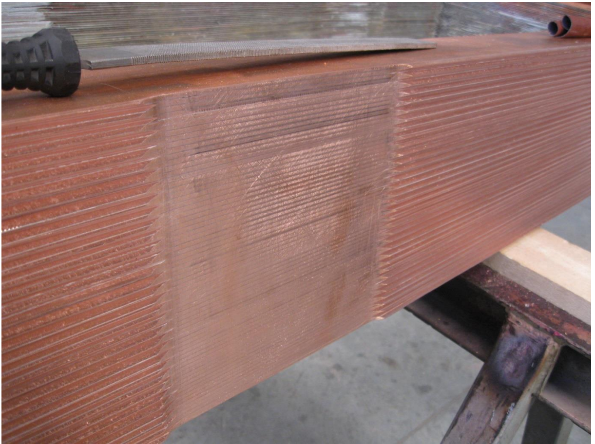
Obr. č. 2. Hřebenovité ofrézování cívky s výběrem pro pólovou rozpěrku
