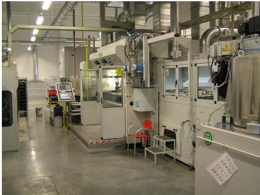
Obrázek 33 Lakovací stroj VenJakob s plochým systémem lakování
