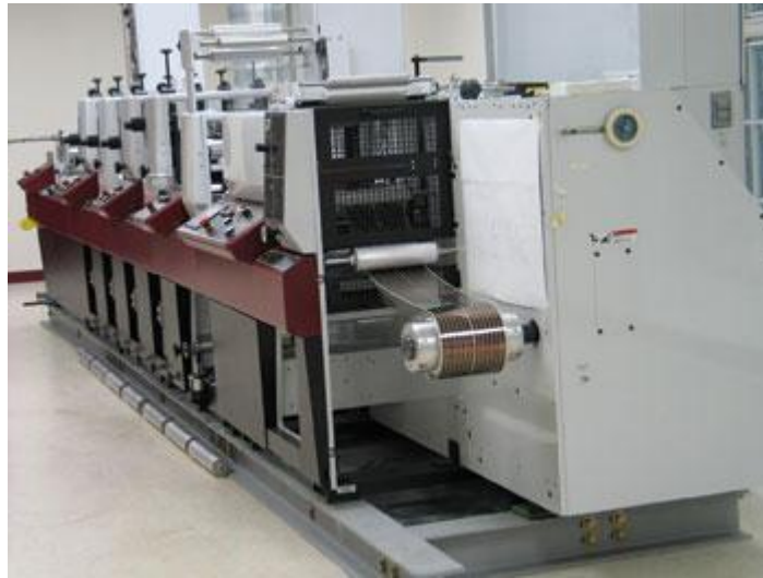
Obr. 12: Stroj na výrobu organických fotovoltaických článků technologií R2R (Roll to Roll) [17]
