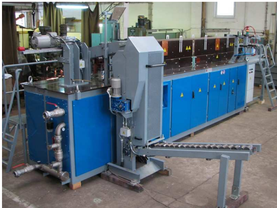
Obr. 3.4 Ohříváček KSO 1200/1,2-A30 o výkonu 1200 kW [25]
