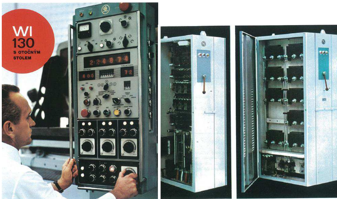
Obr. 2.2 - Ukázka ovládacího panelu a elektrického rozvaděče stroje 2. generace. Na obrázku stroj ŠKODA WI 130 [5]
