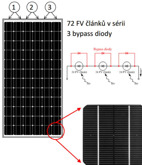
Obrázek 31: Vliv stínění FV panelů [14]
