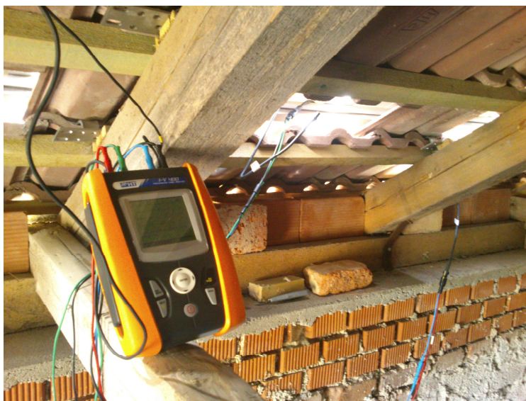
Obrázek 29: Měření V-A a výkonových charakteristik modulu
