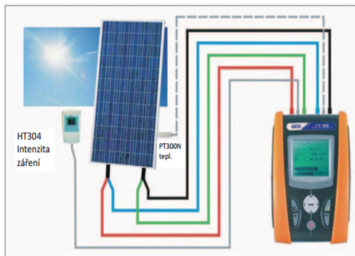
Schéma připojení I-V analyzátoru k FV panelu [21]
