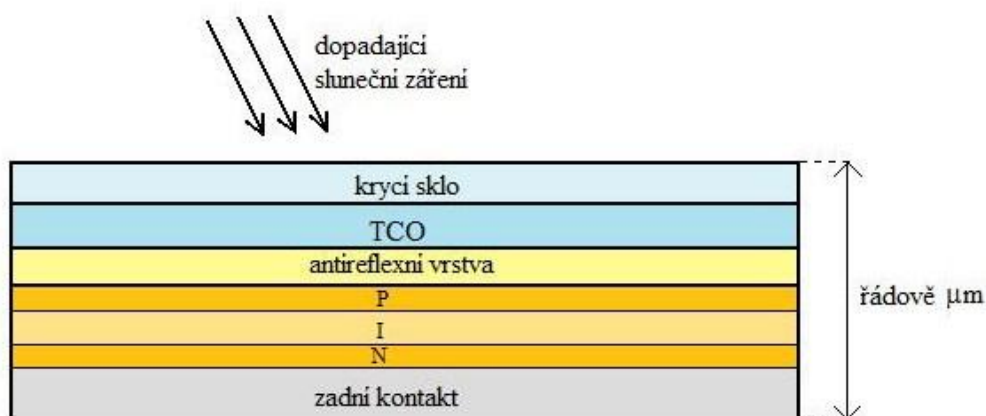
Obr. 2.1 Struktura solárního článku II. generace
