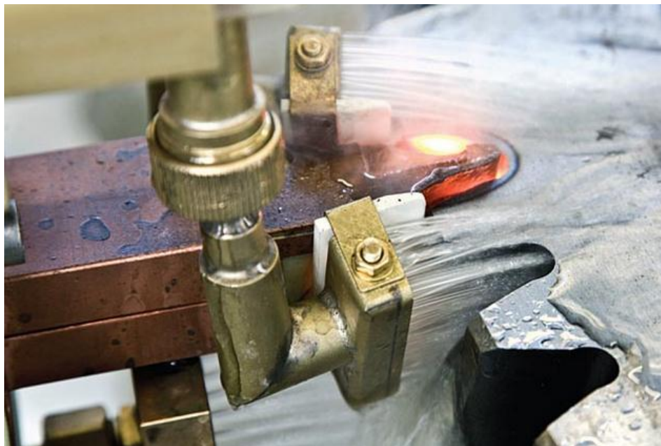
Obr. 29: Kalení zub po zubu [30]
