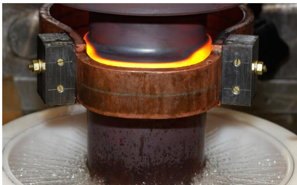
Obr. 27: Povrchové kalení válce v praxi[29]
