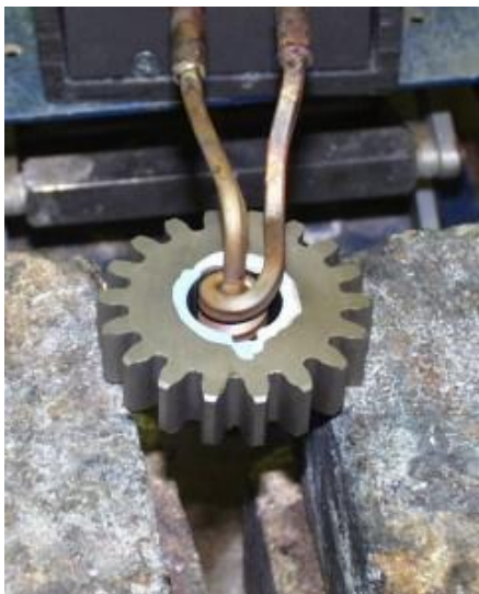
Obr. 41: Ohřev ozubeného kola před montáží na hřídel, ohřev ložisek[34]
