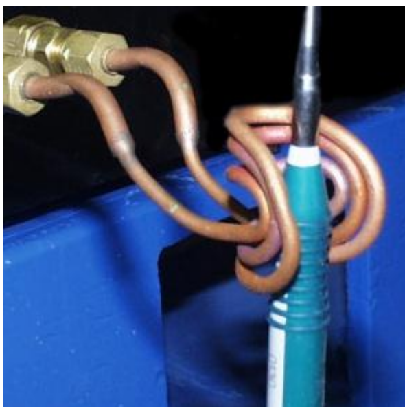
Obr. 37: Lepení plastového madla ručního nářadí[37]
