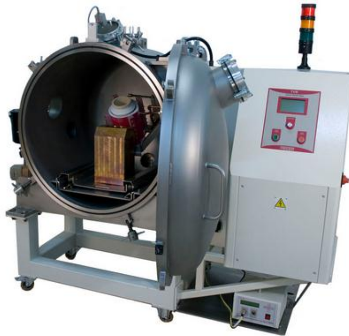
Obr. 22: Indukční vakuová pec pro tavení titanu, TiAl a nerezové oceli [26]
