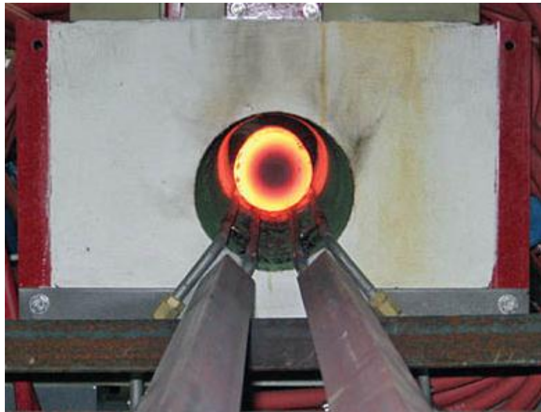
Obr. 24: Provoz indukčního prohřívacího zařízení s vývalkem uvnitř[27]
