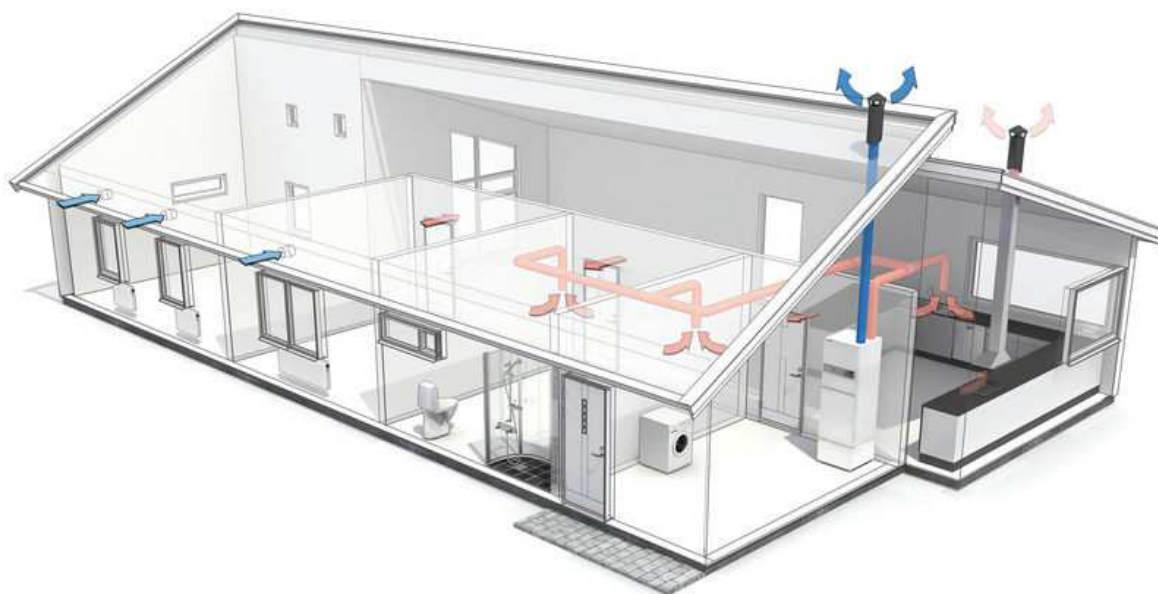
Obr. 6 – TČ s využitím odpadního vzduchu [Zdroj: 6]
