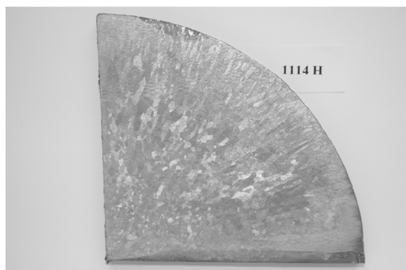
Obr.č.12 a č.13: Tavba č. 1112 vzorek odebraný z hlavové části označen jako H a patní části jak P
