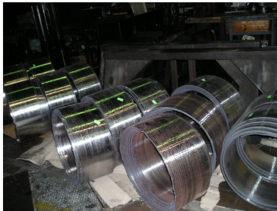
Obr.č.14.: Pohled na vyfrézované pasy v tloušťce 8 mm po teplém válcování
