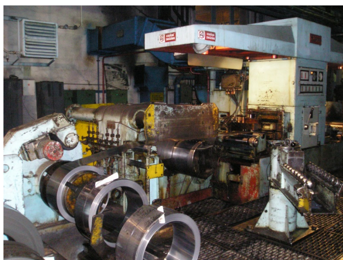
Obr.č. 16.: Válcovací stolice dvacetiválec Škoda ve společnosti KORO, a.s.
