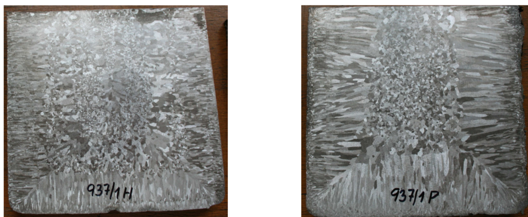
Obr. č. 18: Makrostruktura litého stavu ingotu – plochá deska
