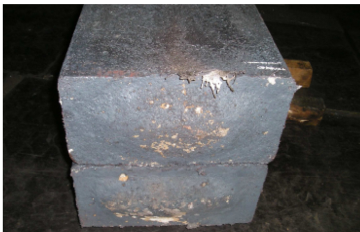
Obr.č.16: Pohled na patní část odlitých plochých ingotů
