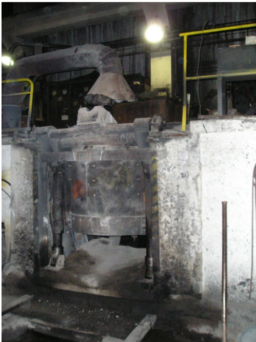
Obr.č.10.: Otevřená středofrekvenční tavící pec SF 100 v levé části a vakuová pec KOPP v pravé části obrázku
