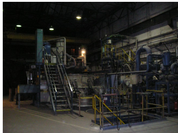
Obr.č.10.: Otevřená středofrekvenční tavící pec SF 100 v levé části a vakuová pec KOPP v pravé části obrázku
