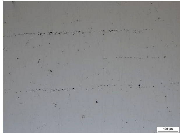
Obr. 35. Vměstek hlinitanového typu, zvětšení 100x
