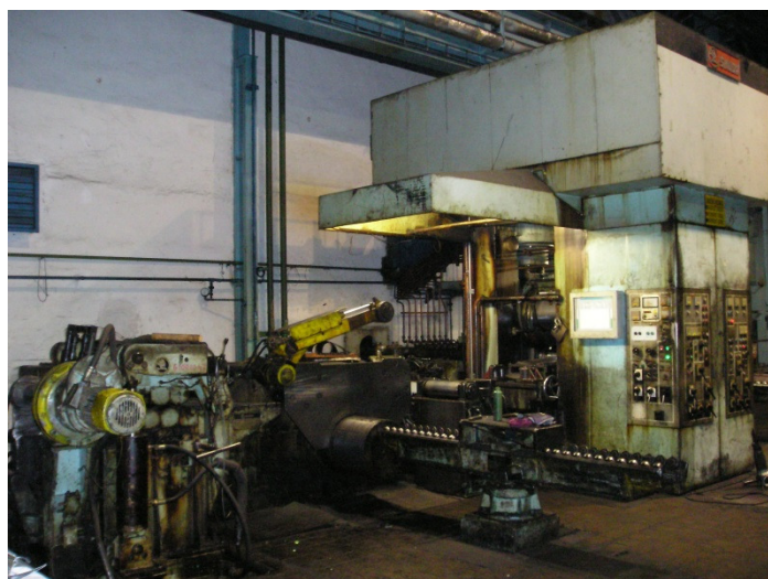
Obr.č.15.: Válcovací stolice KVARTO ŠKODA ve společnosti KORO, a.s.
