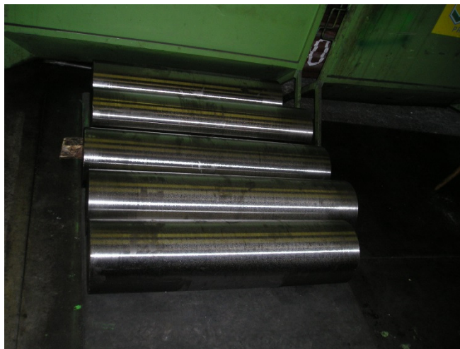
obr.č.11.: Apretované ingoty před ohříváním a tvářením
