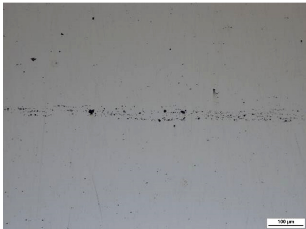
Obr. 34. Vměstek hlinitanového typu, zvětšení 100x
