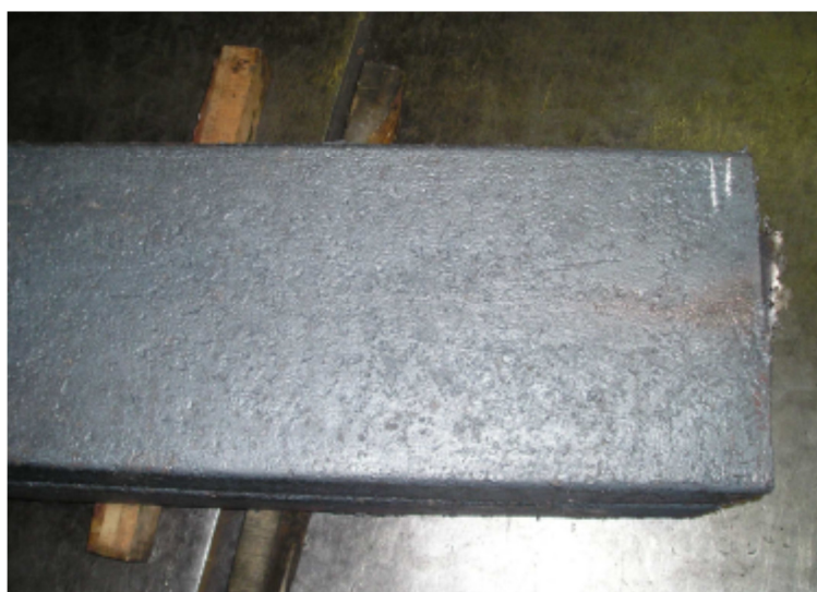
Obr.č.15: Povrch odlitých plochých ingotů
