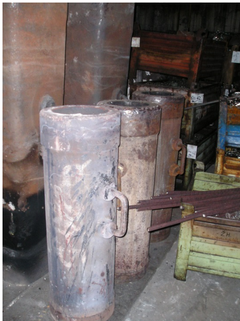
Obr.č.9.: Hematitové kokily pro odlévání niklových slitin v KORO, a.s.
