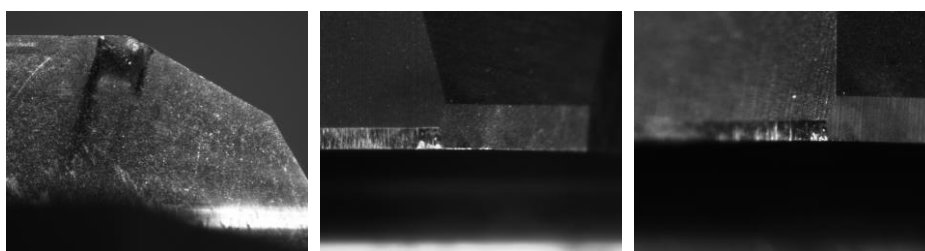
Snímky druhého břitu, zleva: čelo; vedlejší hřbet VB_B = 66 \text{ [}\mu\text{m]} ; hlavní hřbet
