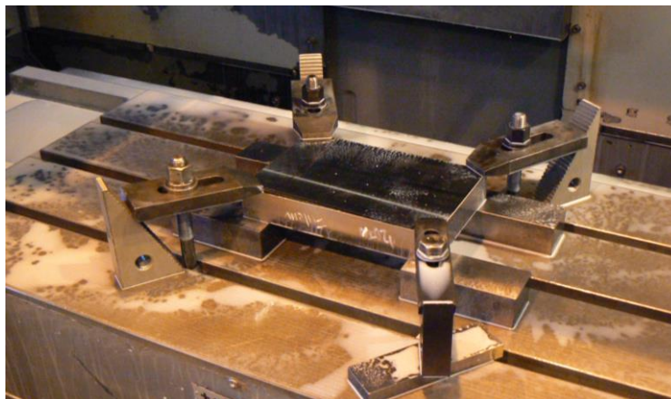
Obrázek 4.3 - Reálný způsob upnutí polotovaru při experimentu
