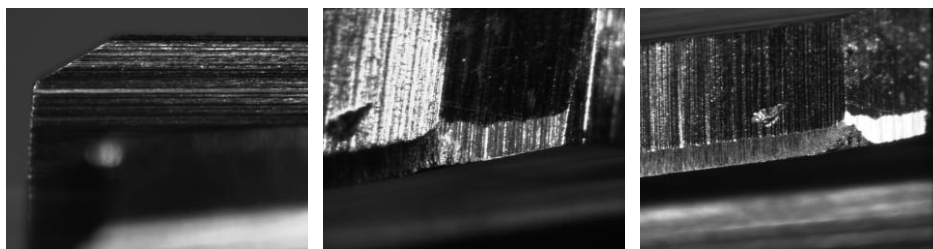
Snímky třetího břitu s opotřebením, zleva: čelo; hlavní hřbet VB_B = 240 [ \mu\text{m} ]; vedlejší hřbet VB_B = 290 [ \mu\text{m} ];
