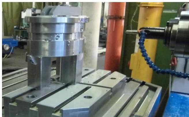
Obrázek 3.4 – Způsob upnutí ložiska při výrobě (neprobíhá přímo výroba tolerované díry, jiný stroj)
