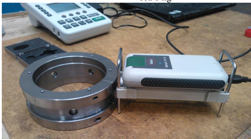
Obrázek P.5 - Měření drsnosti drsnoměrem A 300
