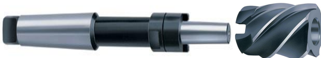
Obrázek 1.5 - Vystružovací nástrčný nástroj od společnosti BECK (upínač + vystružovací hlava) [7]
