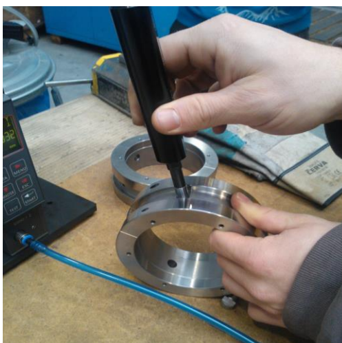
Obrázek P.3 - Měření rozměru vzduchovým kalibrem
