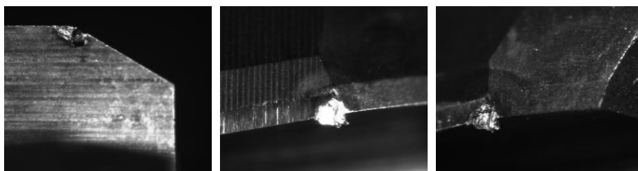
Snímky čtvrtého břitu s opotřebením a nárůstkem, z leva: čelo KB = 176 \text{ [}\mu\text{m]} ; vedlejší hřbet VB_B = 204 \text{ [}\mu\text{m]} ; hlavní hřbet VB_B = 163 \text{ [}\mu\text{m]}
