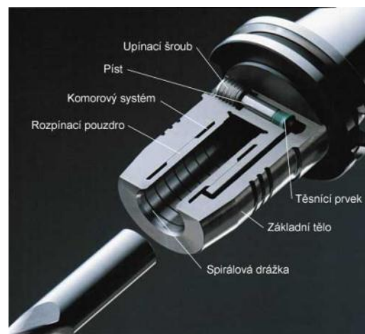
Obrázek 20 - Hydraulický upínač [XVII]
