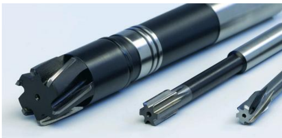
Obr. 2.11. Výstružníky monolitní a s pájenými břity [20]
