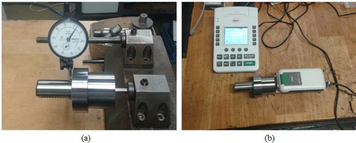
Obr 3.4.(a) Měření radiální házivosti, (b) měření drsnosti povrch
