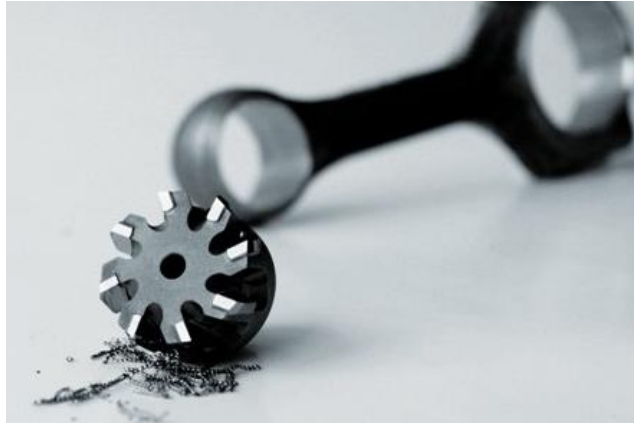
Obr. 2.8. Výstružník s cermetovými bříty [12]
