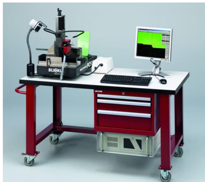
Obr. 4.3. Optický mikroskop Multicheck PC500[31]
