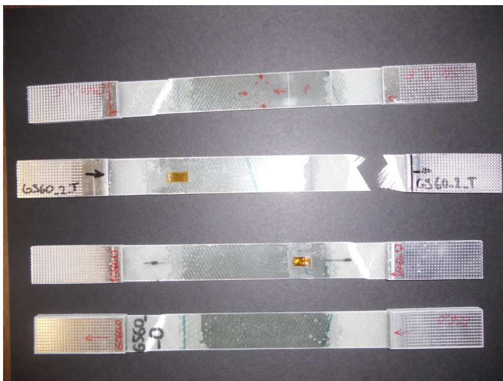
Obr. A. 1 Porušené vzorky [-60,60] s po tahové zkoušce
