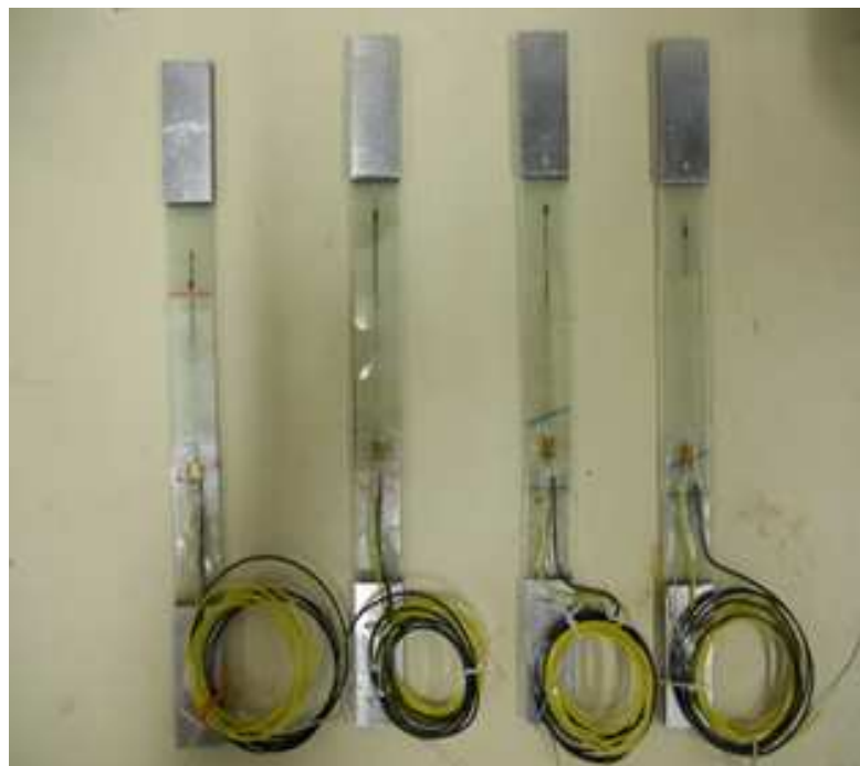
Obr. 46 Laminátové vzorky vybavené lineárními fóliovými tenzometry připravené ke zkoušení
