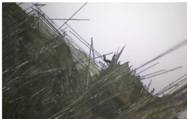
Obr. 41 Mikroskop Nikon Eclipse LV100 a snímek vláken v okolí lomu vzorku [\pm 30]_s , pořízený tímto mikroskopem.
