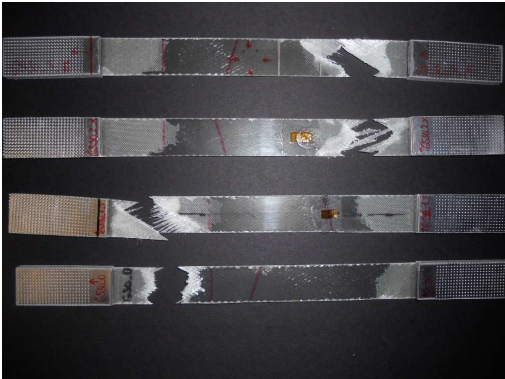
Obr. A. 3 Porušené vzorky [-30,30] s po tahové zkoušce
