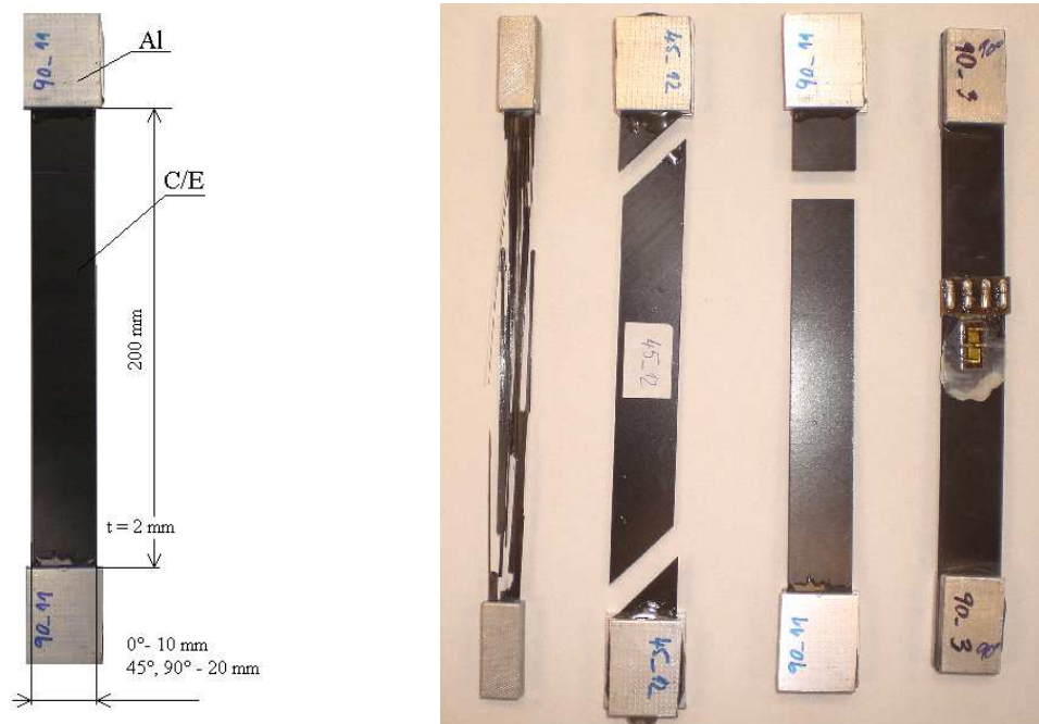
Obr. 21 Zkušební vzorky pro zatěžování mĳivým tahem
