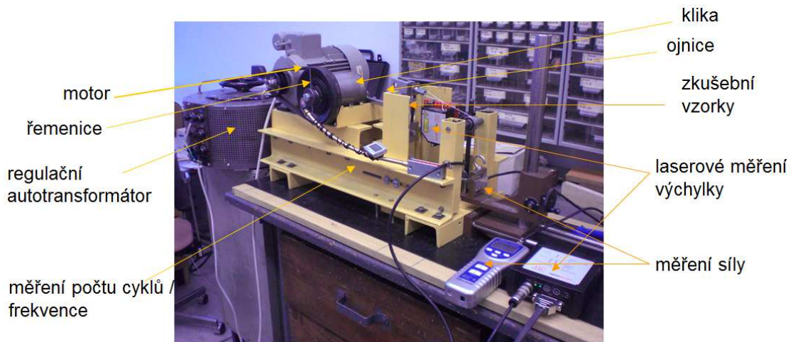
Obr. 23 Zkušební stroj pro únavové zkoušky C/E laminátu v ohybu
