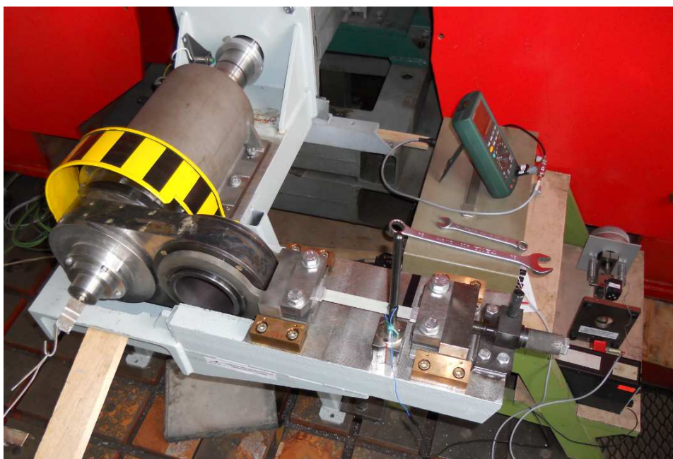
Obr. 30 Zkušební stroj použitý pro zkoušky tkaninových vzorků cyklickým tahem. Laminátový vzorek je světlý proužek
