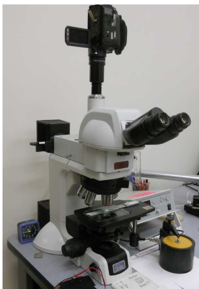
Obr. 41 Mikroskop Nikon Eclipse LV100 a snímek vláken v okolí lomu vzorku [\pm 30]_s , pořízený tímto mikroskopem.
