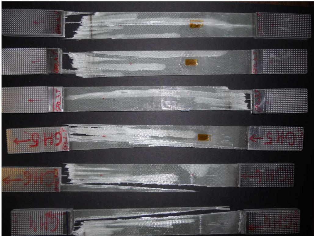
Obr. A. 5 Porušené vzorky [0^{\circ}]_8 po tahové zkoušce
