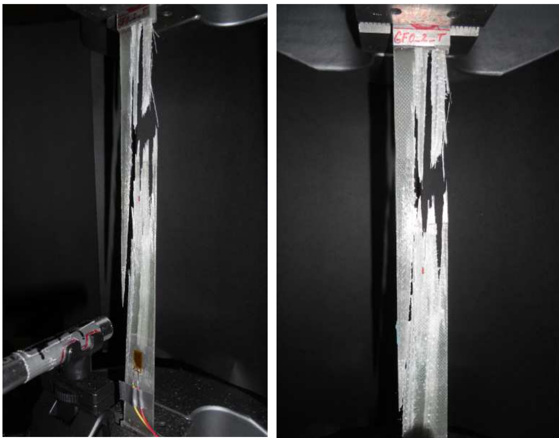
Obr. 71 Finální porušení vzorků [0]_8 po únavové zkoušce
