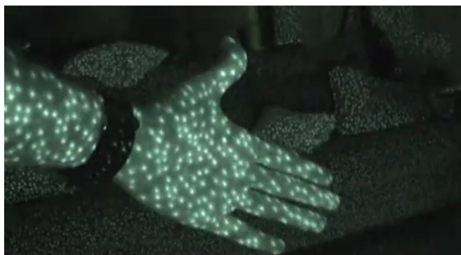
Obrázek 2: IR zdroj promítá síť bodů, převzato z [4]
