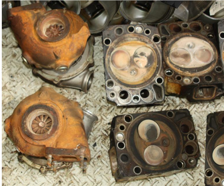
Obr. 7 Poškozená turbodmychadla (vlevo) a prasklé hlavy válců
