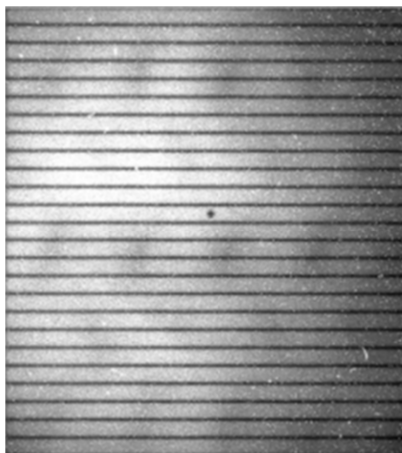
Obr. 3.2 Článek měřený metodou fotoluminiscence, převzato [19]
