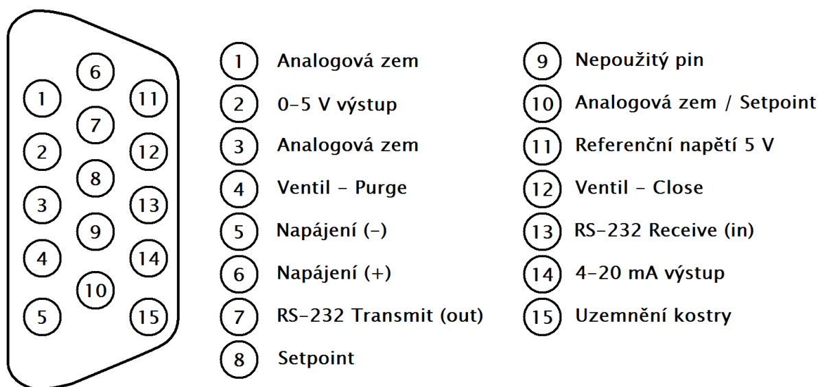
Obr 1.4 Zapojení pinů v konektoru DE-15 [1]
