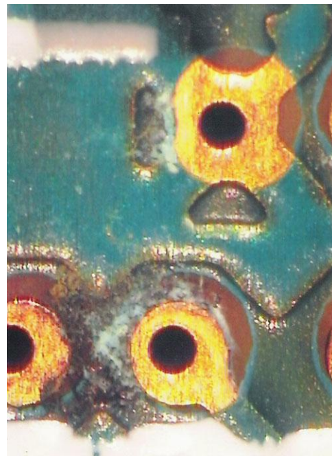
3.1 Koroze způsobená tavidlovými zbytky [11]
