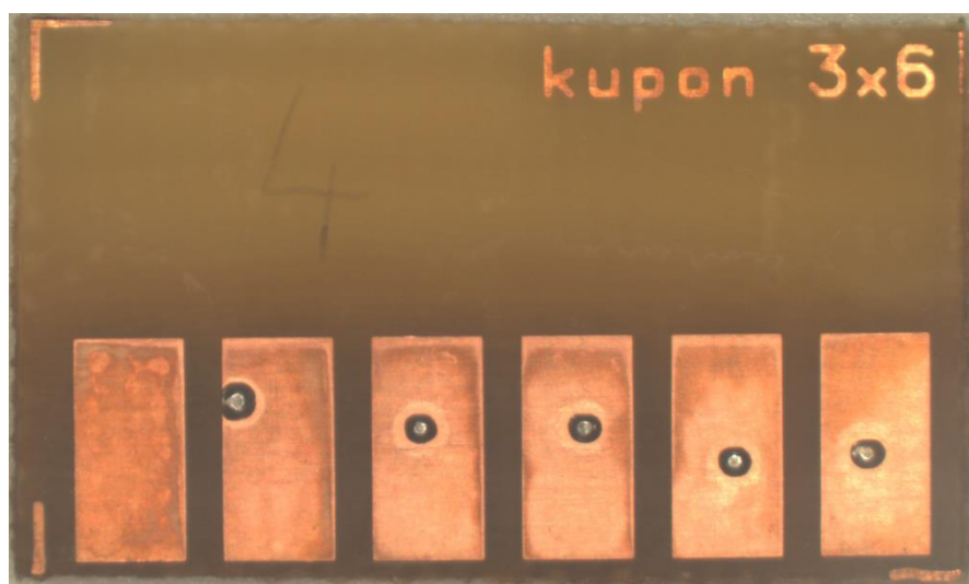
Obr. 3.17 Kupon po přetavení s užitým tavidlem č. 4 zvětšený 47x
