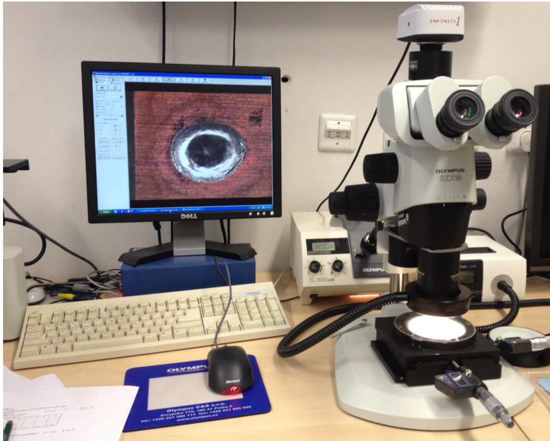
Obr. 3.8 Mikroskopické pracoviště s mikroskopem Olympus SZX10
