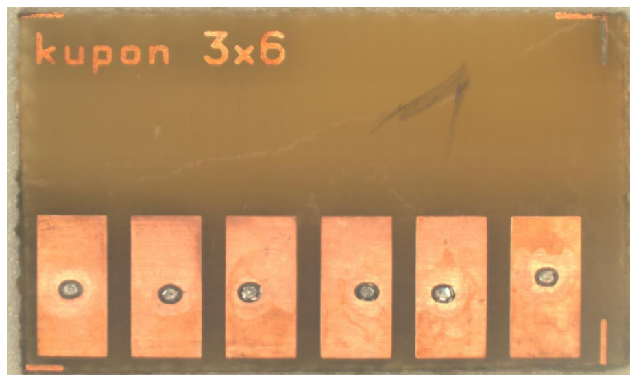
Obr. 3.11 Kupon po přetavení s užitým tavidlem č. 1 zvětšený 47x
