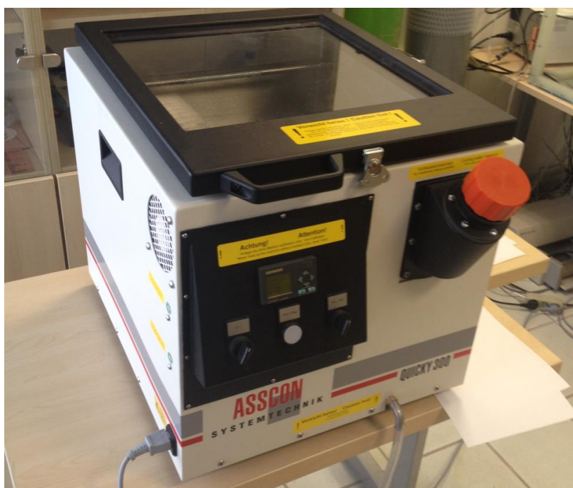
Obr. 3.5 Pájecí pec pro pájení pomocí horkých par
